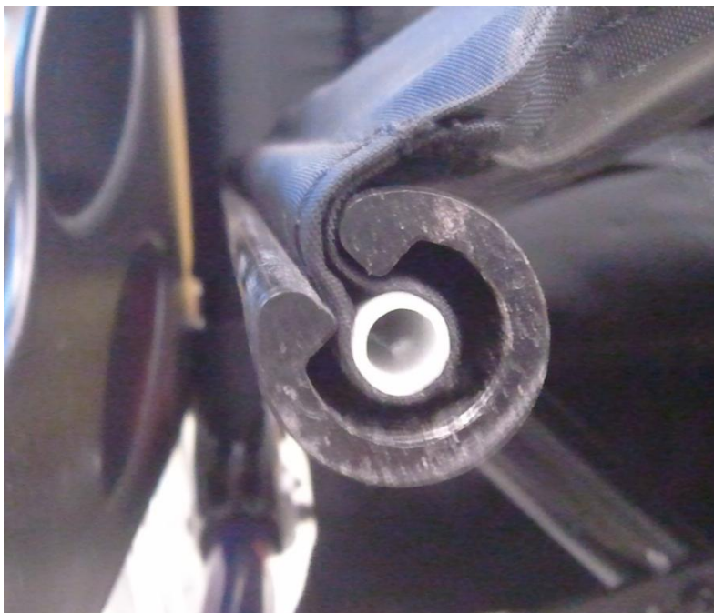
Kuva 13 Kiinnityspalikoiden asennusreiät ennen istuinkankaan poistoa
