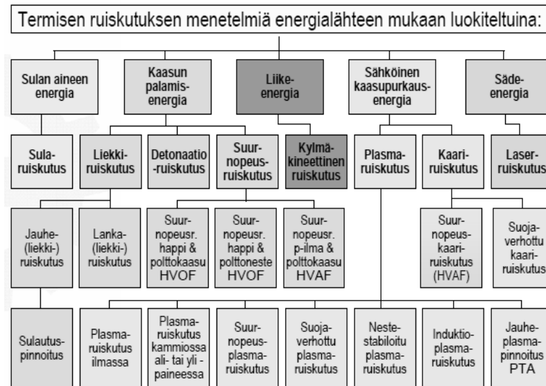
Kuva 8. Termisen ruiskutuksen menetelmiä energialähteen mukaan luokiteltuina. [ 10, s. 14. ]
