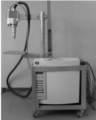
Kuva 15. FG5001kylmäplasmalaitteisto varustettuna RD1004 plasmasuuttimella.
