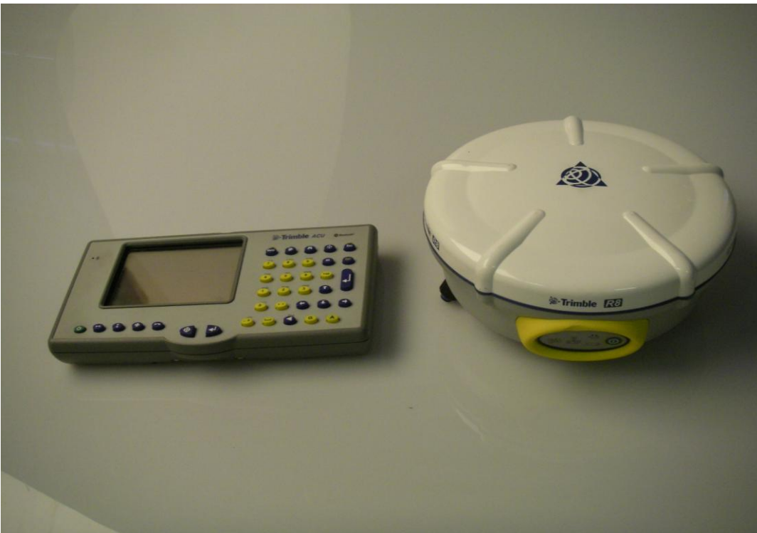
Kuva 5. Trimble ACU-maastomikro ja R8-vastaanotin.
