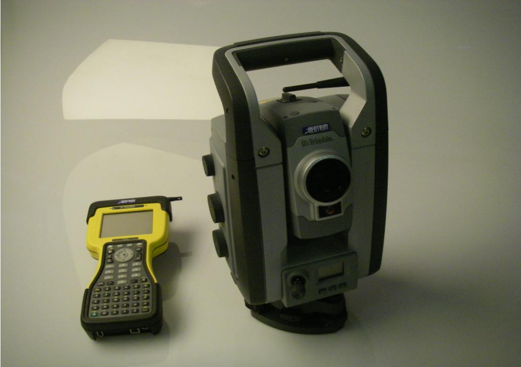
Kuva 4. Trimble TSCU2-maastomikro ja VX Spatial Station-takymetri.
