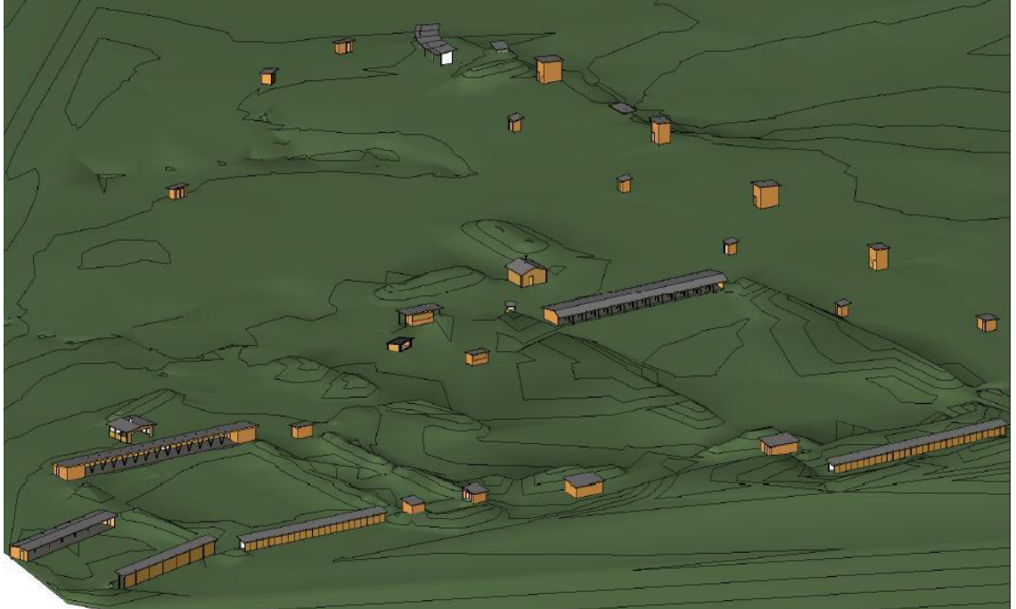
Kuva 9. Revit Architecturella mallinnetut rakennukset mitta-aineistosta luodussa topografiassa.
