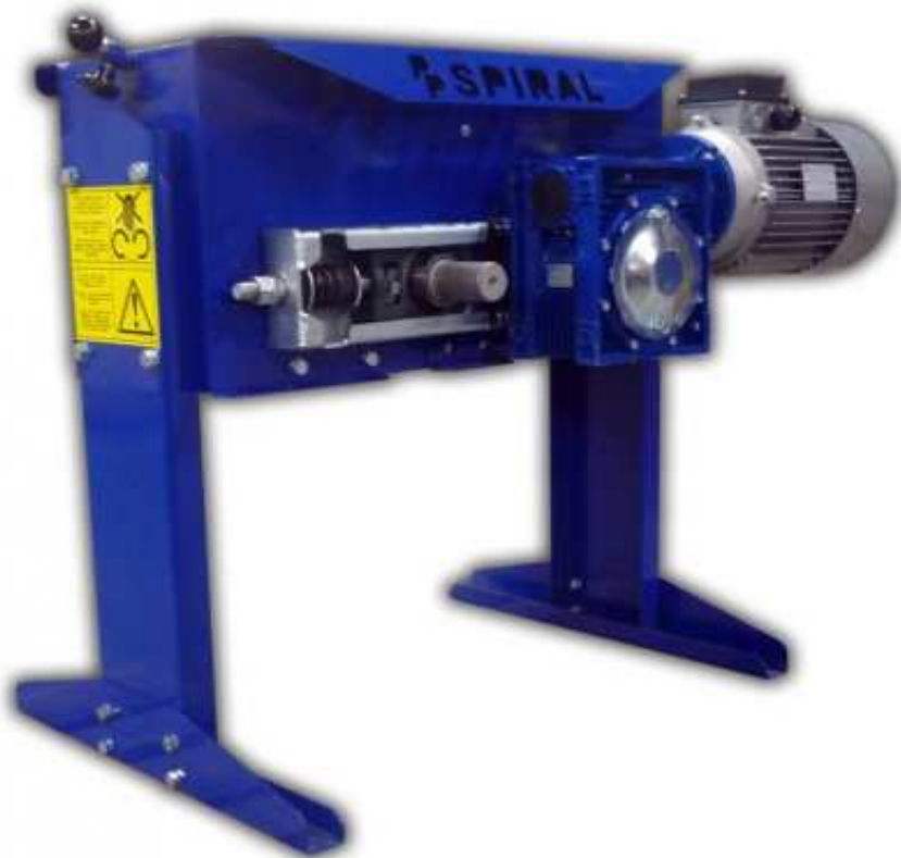
Kuva 2. Kulmavaihteella toteutettu GW 200-valssimylly.
