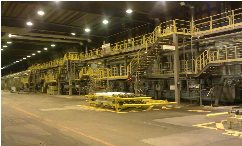
Kuva 4. HP2:n hehkutus- ja jäähdytysvyöhyke
