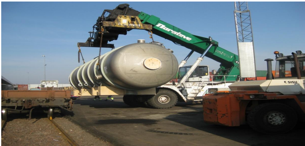
Kuva 6. Terässäiliön lastaus kurottajan avulla VOSK-vaunuun (Easmarin arkisto).
