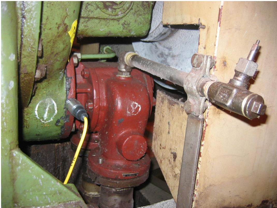
KUVA 4. Pääöljypumppu planeettavaihteistossa. Kuva Joni Makkonen
