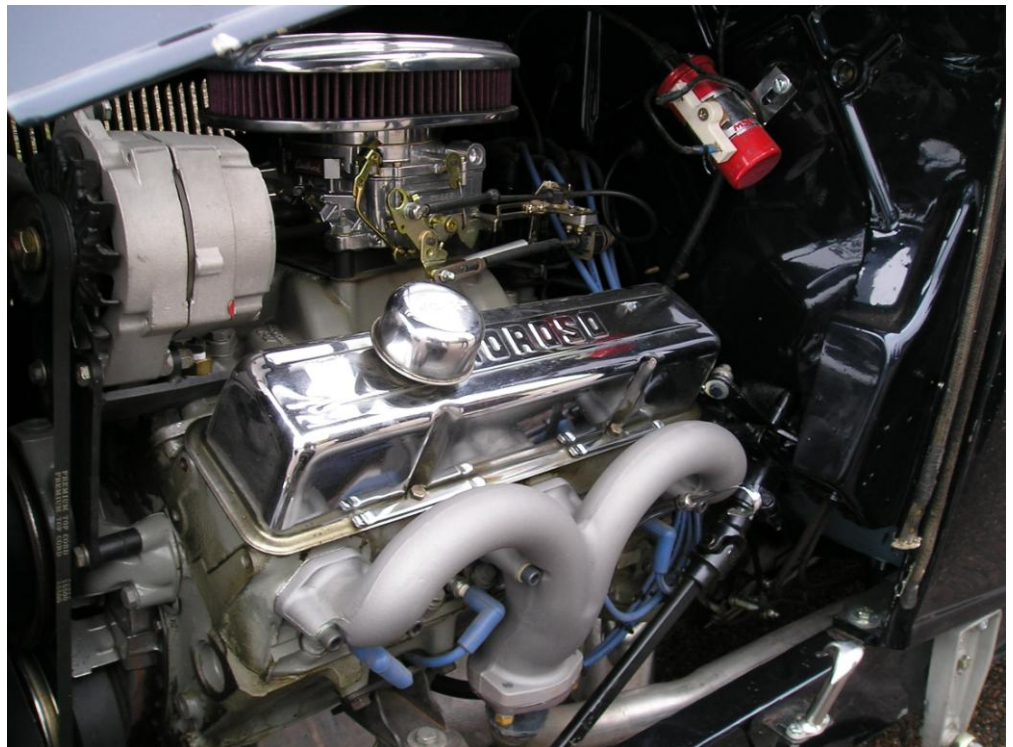
Kuva 10. Kuvassa on Hot Rod 1:n Chevroletin 350-kuutiotuuminen V8-moottori. Sytytyspuola sijaitsee oikealla yläkulmassa ja vasemmalla on laturi. Kuvassa olevat siniset sytytysjohtimet päätyvät virranjakajaan, jonka sisälle on asennettu sytytysmoduuli.
