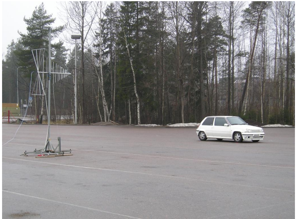
Kuva 18. Kuvassa suoritetaan Renault R5 GT:n laajakaistaisen pystypolarisoituneen säteilyn mittausta pystyantennilla auton oikealta puolelta.
