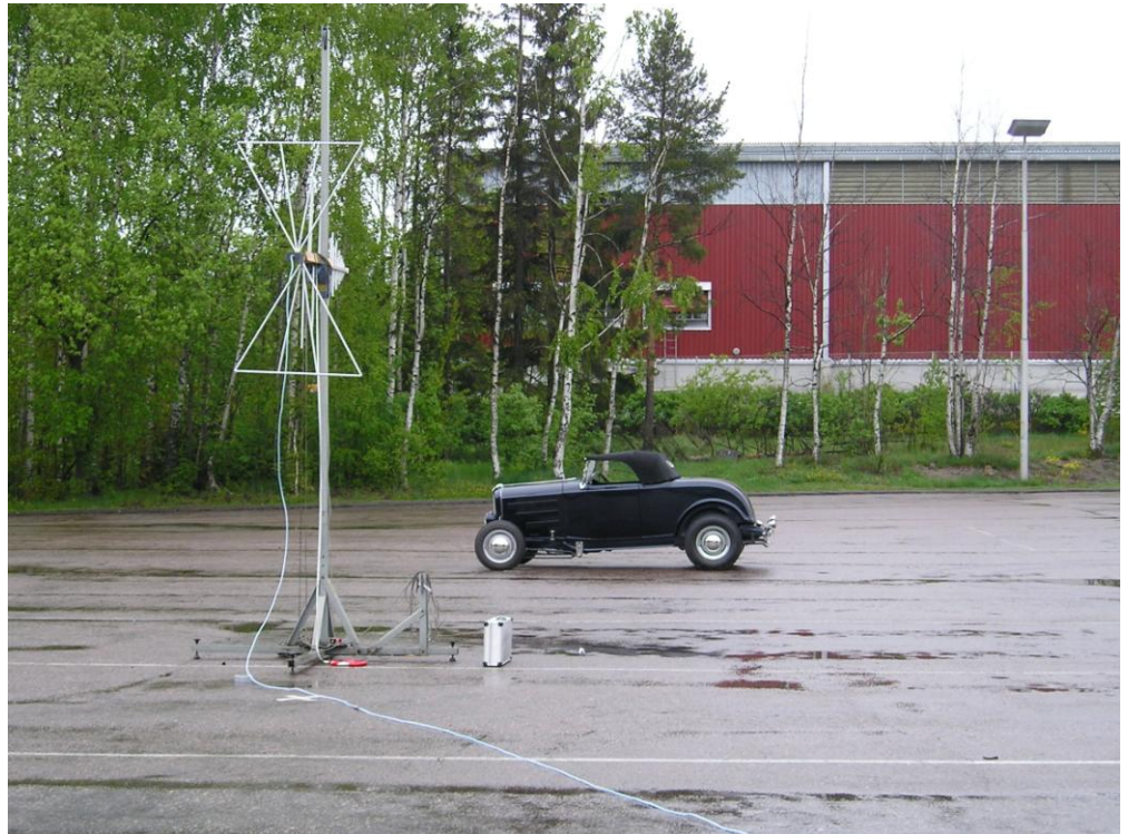
Kuva 16. Kuvassa suoritetaan Hot Rod 1:n laajakaistaisen pystypolarisoituneen säteilyn mittausta pystyantennilla auton vasemmalta puolelta.
