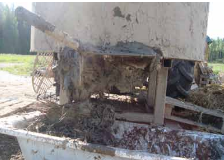
Kuvasarja 26. Savi-olkiseos puristettiin harkoiksi itse rakennetulla laitteella. Viimeisessä kuvassa valmiita kevytsaviharkkoja. Kuvat: Matti Liukkonen 2010
