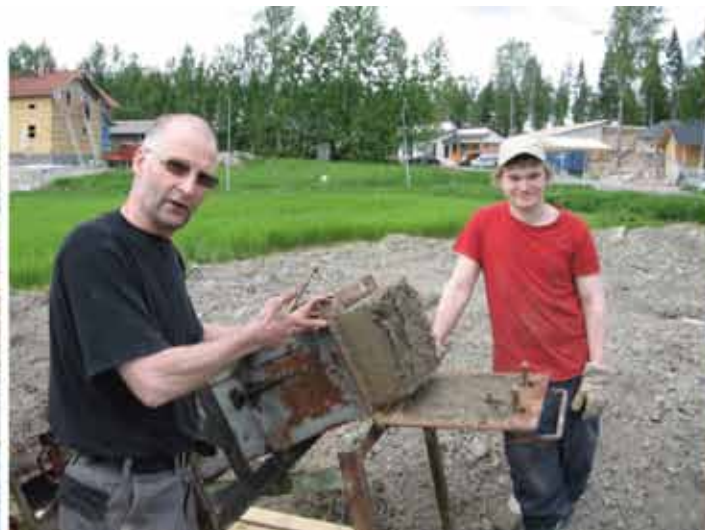
Kuvasarja 26. Savi-olkiseos puristettiin harkoiksi itse rakennetulla laitteella. Viimeisessä kuvassa valmiita kevytsaviharkkoja. Kuvat: Matti Liukkonen 2010
