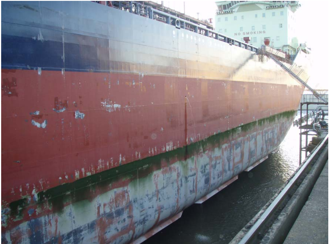
Kuva 4. Painolastivesiviivaan muodostunutta kasvustoa M/T Nesteessä(Neste Oil/Oskari Sääntti)
