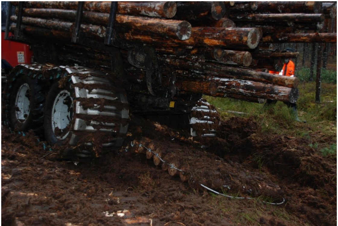
KUVA 4. Kuormatraktori on liukunut pois ajosiltamattojen päältä.
