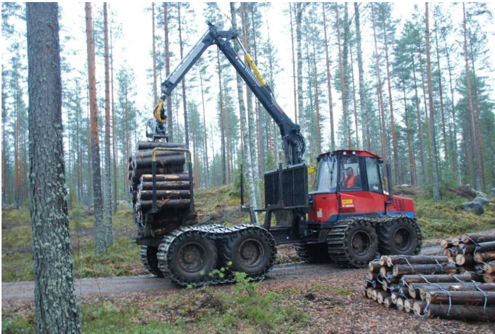
KUVA 11. Ajosiltamattopari kuormatraktorin kyhdissä
