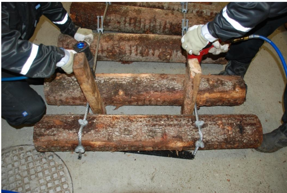
KUVA 7. Pölkkyjen välit saatiin oikeaksi puujigien avulla
