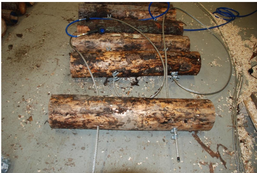
KUVA 2. Kolmannessa mattoparissa keskimmäiset vaijerit kulkivat pölkyn sisällä.
