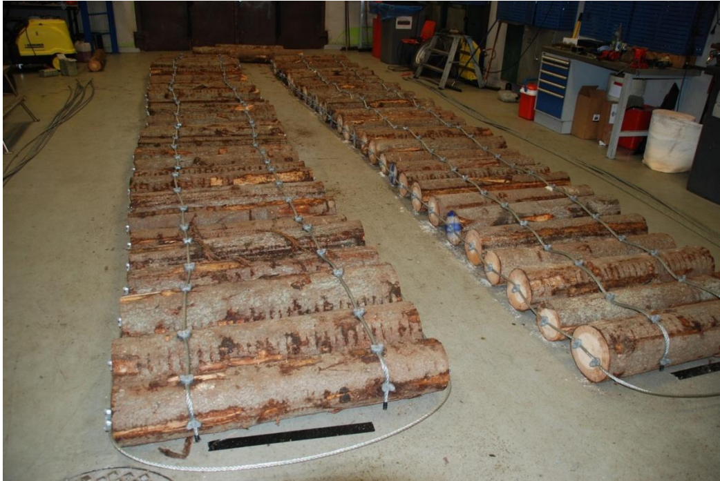
KUVA1. Valmis ajosiltamattopari, jossa teräsvaljerit kulkevat pölkkyjen päällä
