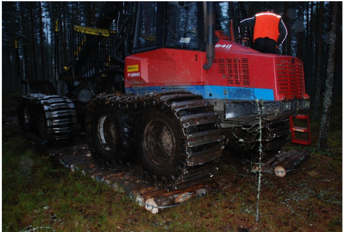
KUVA 5. Kuormatraktori ajosiltamattojen päällä.
