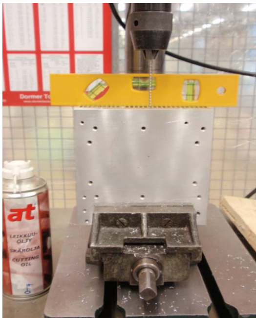
Kuva 28. Termoelementin poraus jäähdytyslementtiin
