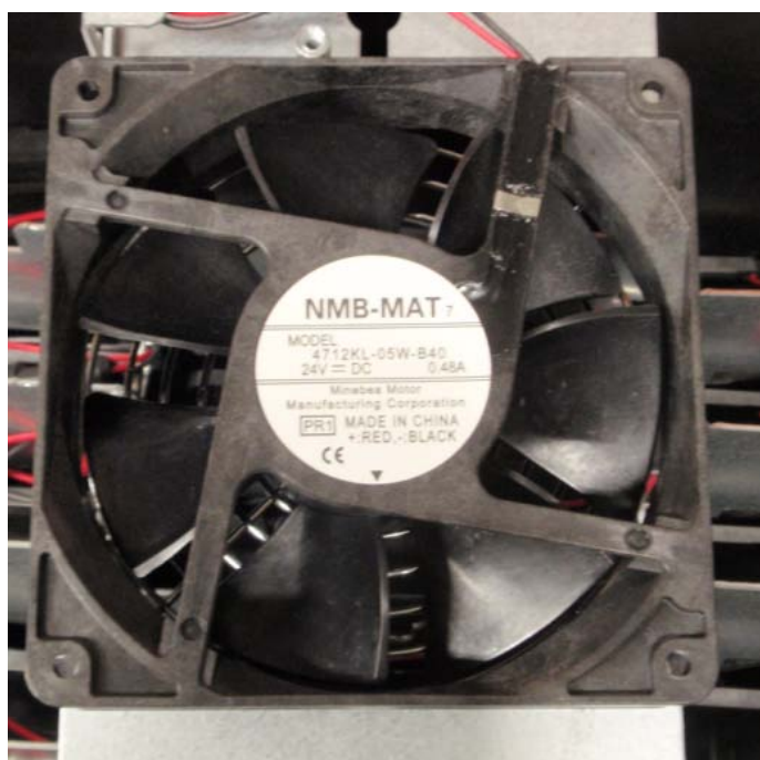
Kuva 31. Testauslaitteistossa käytetty puhallin
