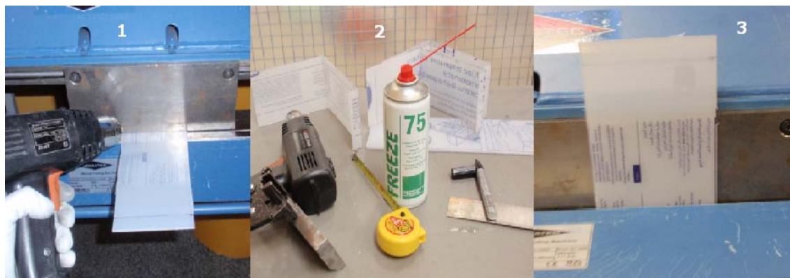
Kuva 32. Muovin kanttaamisen työvaiheet
