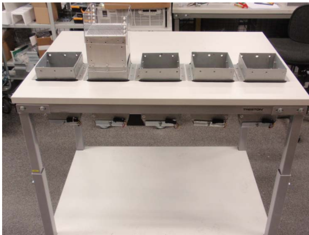
Kuva 34. Jäähdytys-elementit asennettuna pöydälle
