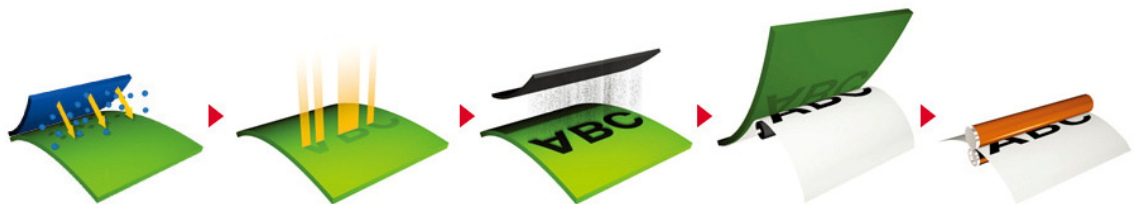
Kuva 1 Kuvanmuodostuksen vaiheet elektrofotografiassa: varaus, valotus, kehitys, siirto ja kiinnitys [Canon Technology: 2009].
