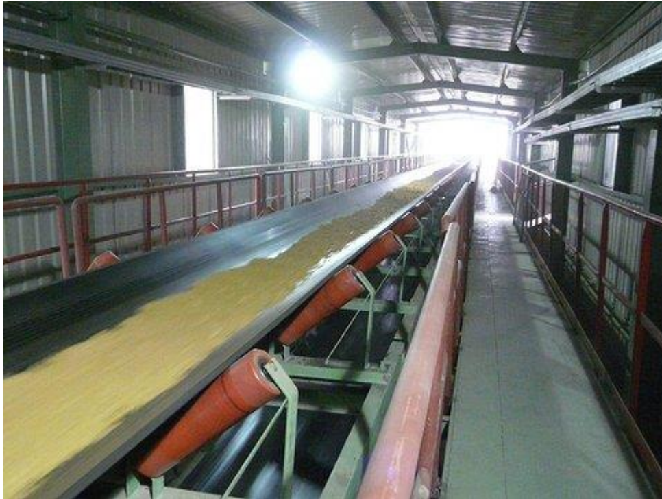
Kuva 3. Hihnakuljetin. (Beumergroupin www-sivut)
