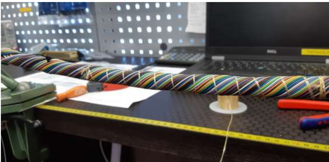
KUVA 8. Valmiiksi punottu johtosarja sidottuna kevlar-nauhalla
