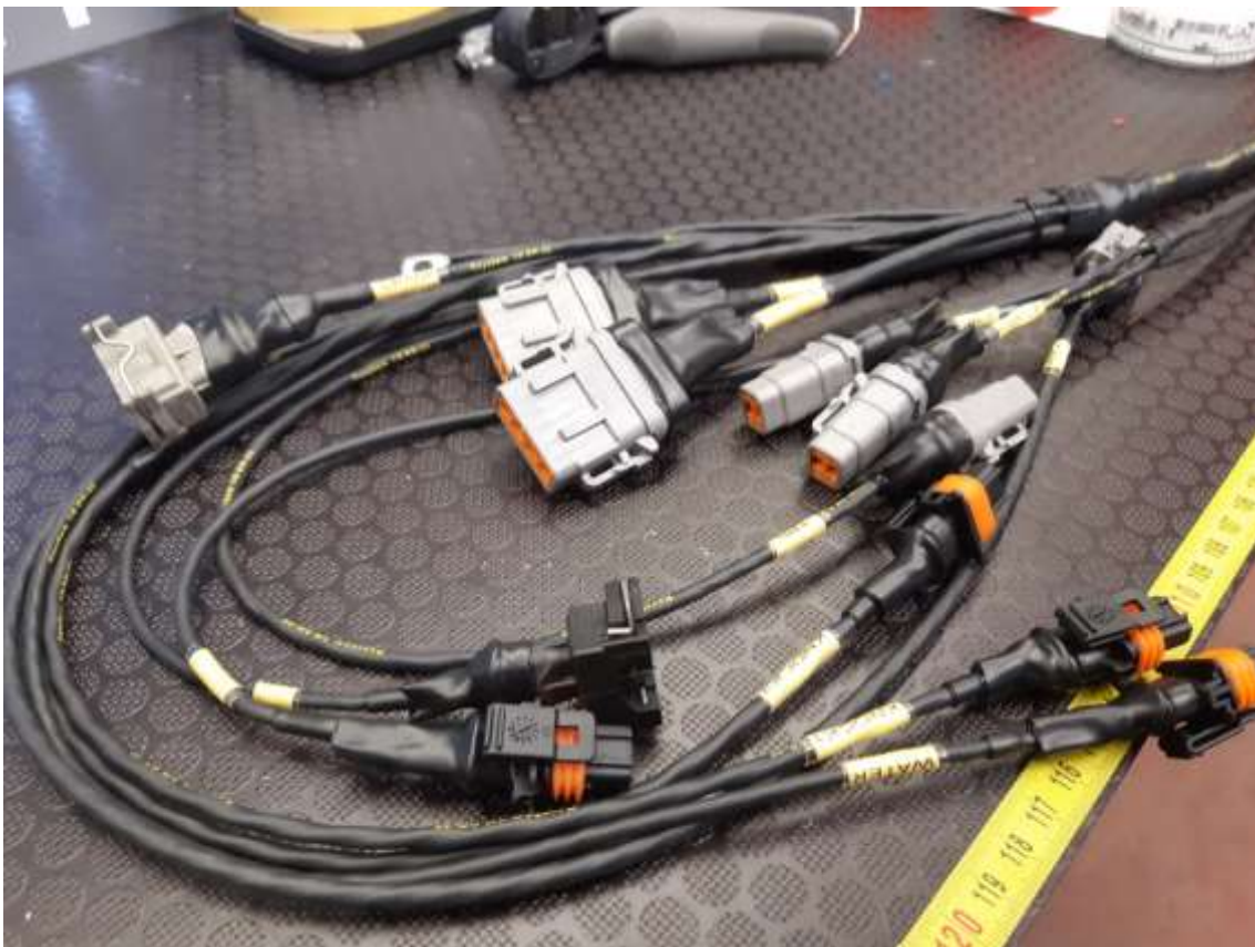
KUVA 4. Liittimien takaosan tiivistäminen Raychem SCL -kutisteella
