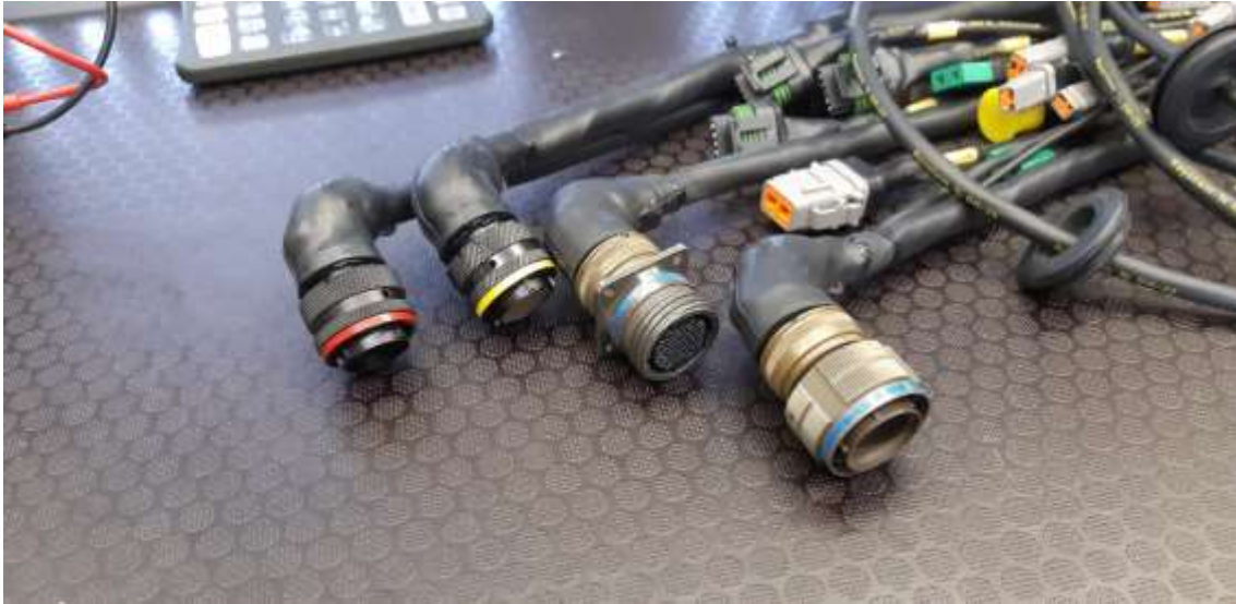
KUVA 5. Liittimet suojattuna kutistemuodoilla
