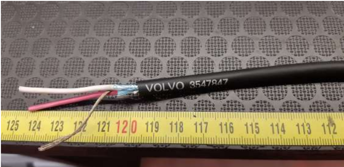
KUVA 2. Volvon valmistaman induktiivisen anturin häiriösuojaus
