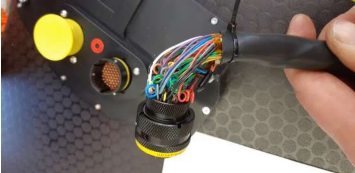
KUVA 10. 55-pinninen Deutsch Autosport -liitin varustettuna huoltosilmukoilla
