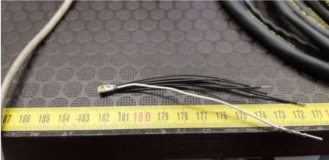
KUVA 12. D609-05 rinnakkaisliitos, jossa seitsemän 22 AWG johdinta
