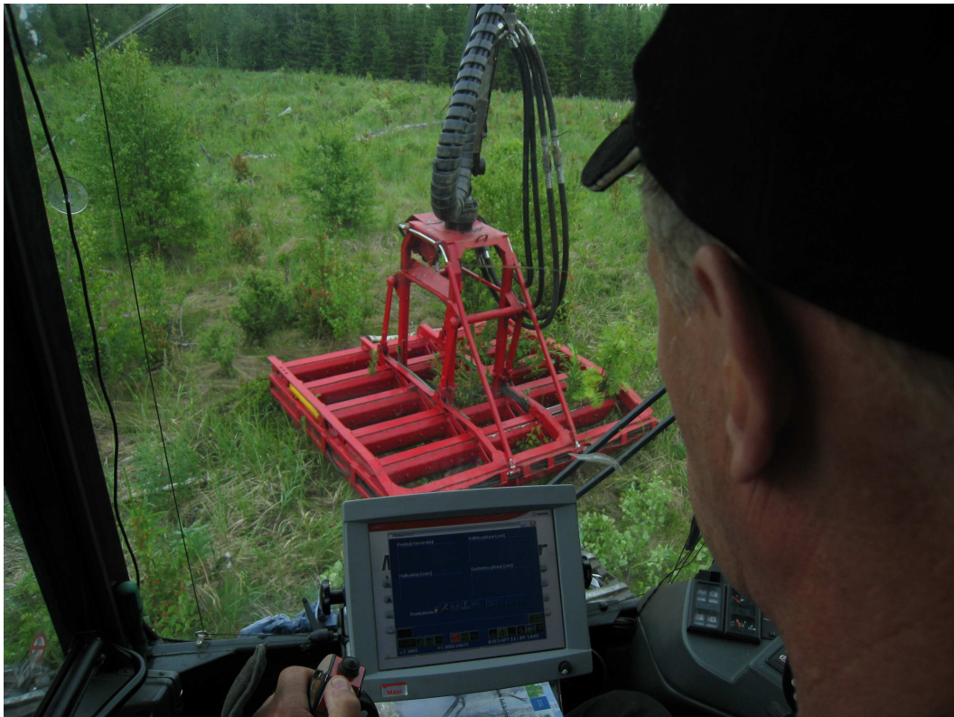
Kuva 2. Matti Salmelan kuljettaman metsäkoneen reikäperkaaja suojaa kuusentaimen, laitteen leuat vetävät ympärillä kasvavan vesakon juurineen irti.
