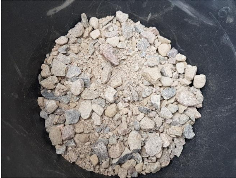
Kuva 10. Sorakiviainesta asfalttimassaan, jossa on vähintään 30 % täysin murskautuneita ja korkeintaan 30 % täysin murskautumatonta kiviainesta
