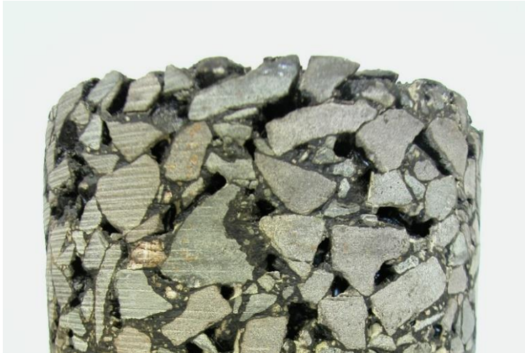
Kuva 6. Poranäyte avoimesta asfalttipäällysteestä (De Ingenieur 2018)
