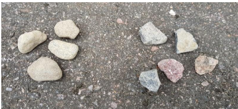
Kuva 11. Vasemmalla murskautumatonta ja oikealla täysin murskautunutta kiviainesta
