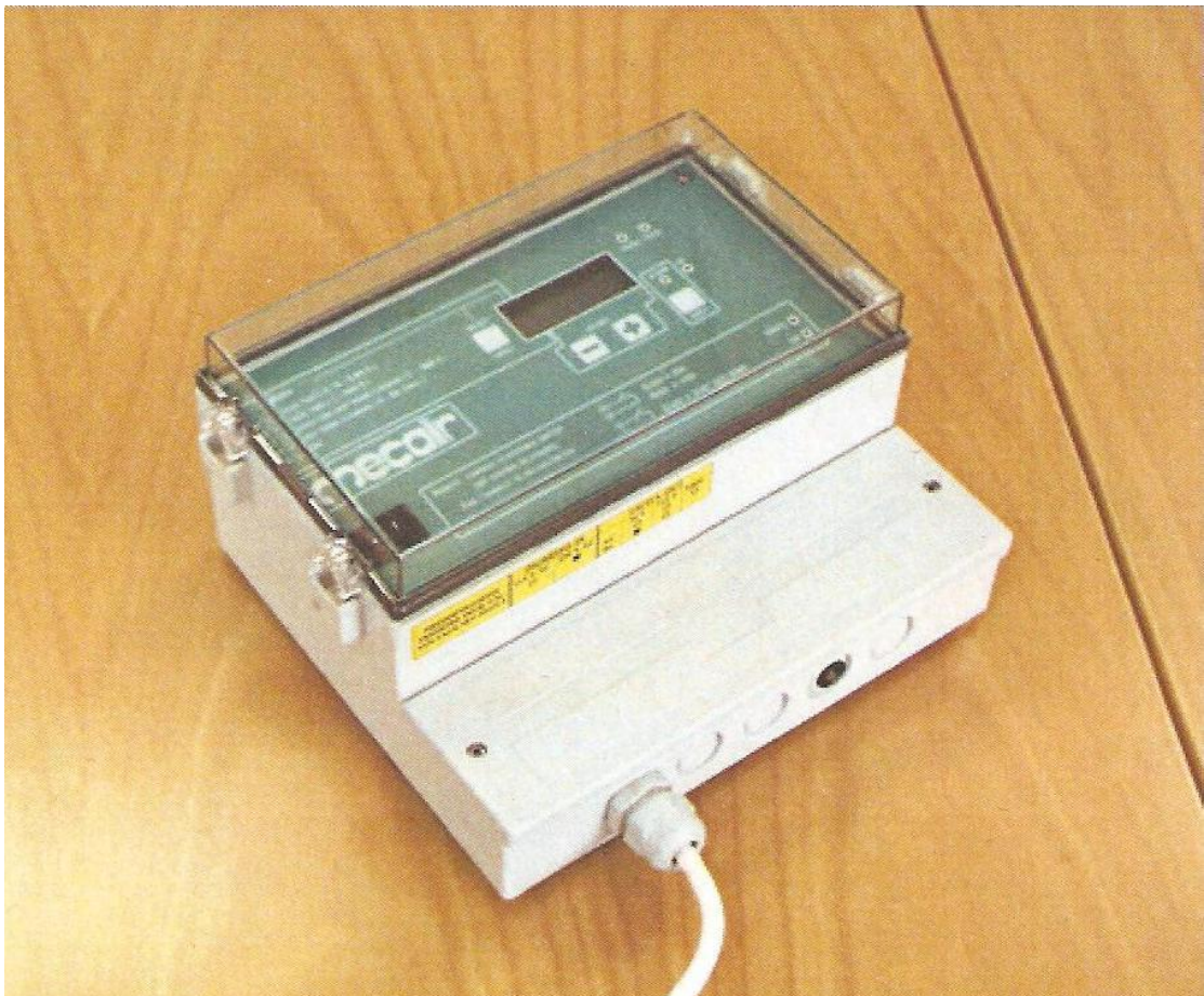
Kuva 8. Suotimen 1200 puhdistusautomaatiikan ajastin/paine-erokytin Mecair "MT" /16/
