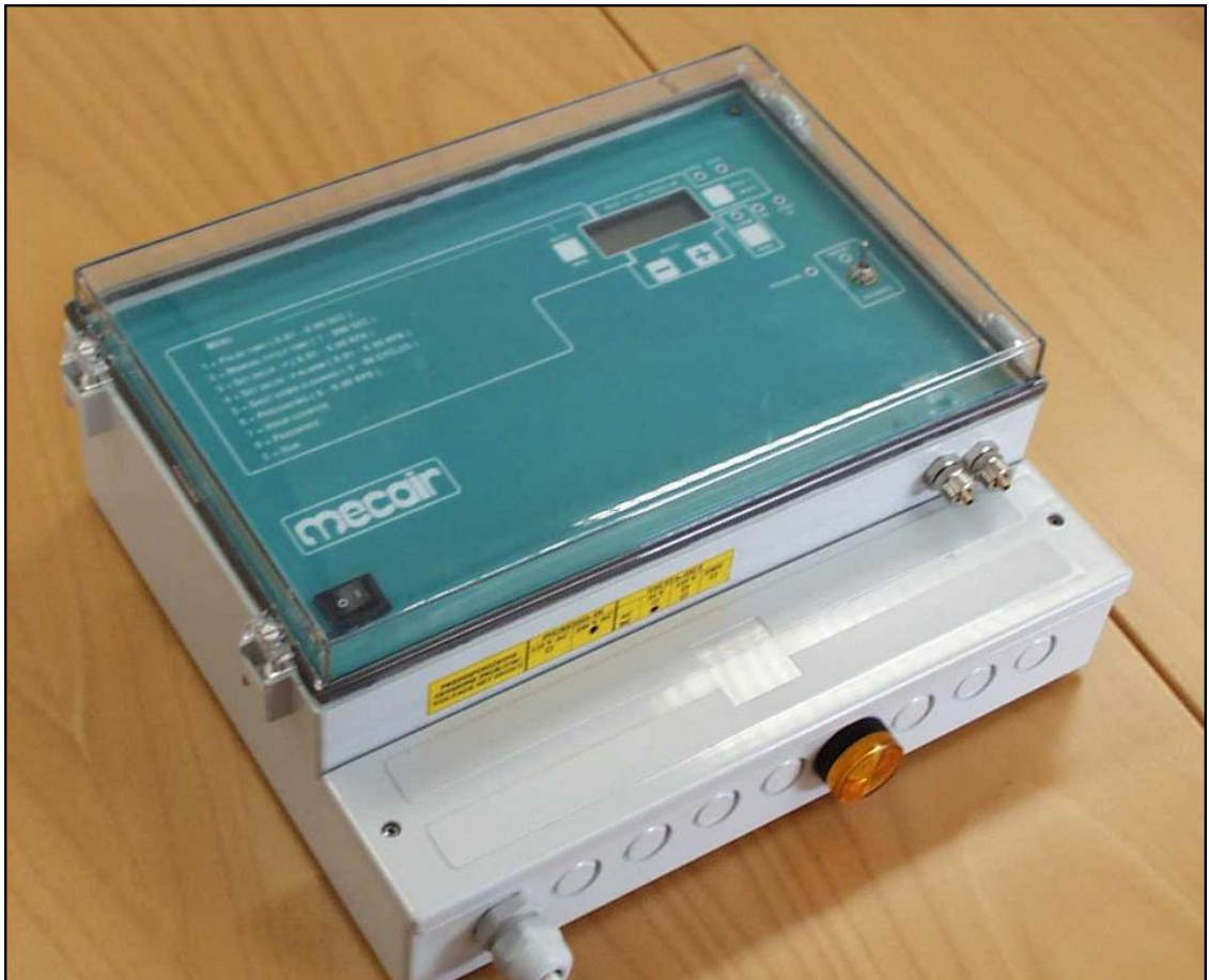
Kuva 7. Suotimen 1250 puhdistusautomaatiikan ajastin/paine-erokytkin Economist "MCS" /15/
