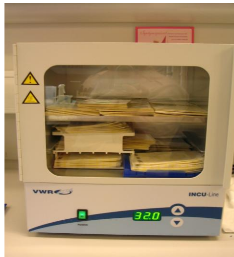
KUVA 5. Lämpökaappi, jossa kasvualustoja
