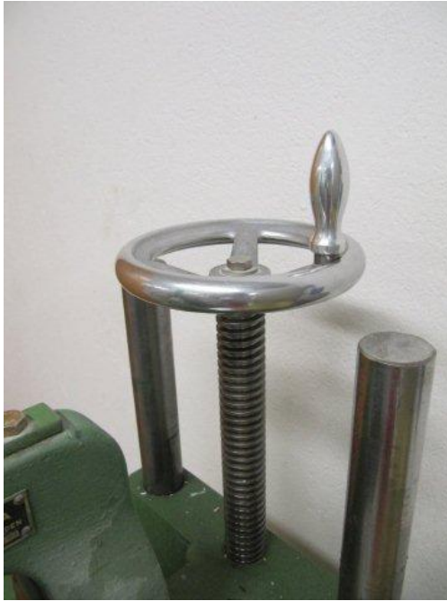
Kuvio 10: Korkeutta voidaan säätää kuvassa näkyvällä vivulla kiertämällä sitä haluttuun suuntaan.(Kuva ja kuvateksti Noora Vierimaa)
