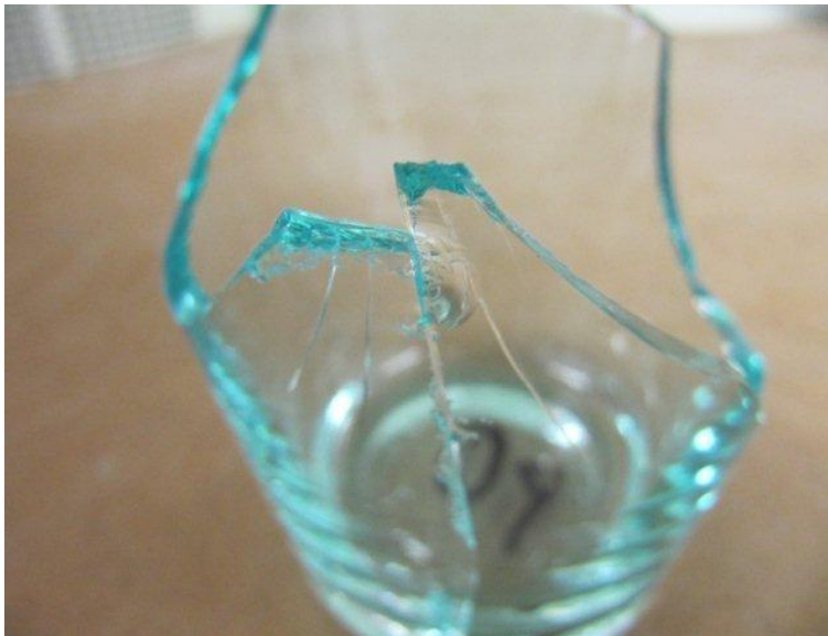
Kuvio 27: Tyypillinen rikkoutumistyyli kyseisille tuotteille. (Kuva ja kuvateksti Noora Vierimaa)
