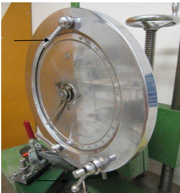
Kuvio 14: Mitta-asteikko. Nuolilla on merkitty vivut, joiden avulla säädetään mitta-asteikkoa haluttuun astelukemaan. (Kuva ja kuvateksti Noora Vierimaa)
