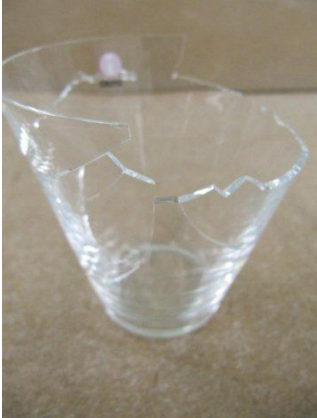
Kuvio 15: Tyypillinen kuva suupuhallettujen lasien rikkoutumistyylistä. Kuvan lasi on rikkoutunut lähes täysin. (Kuva ja kuvateksti Noora Vierimaa)
