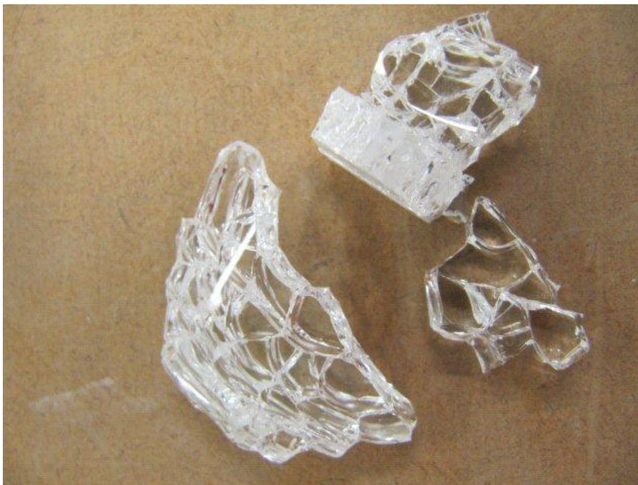
Kuvio 6: Kuva temperoidun lasin rikkoutumistyylistä. (Kuva ja kuvateksti Noora Vierimaa)
