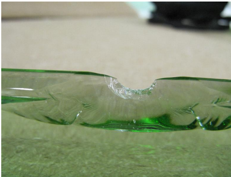
Kuvio 22: Tyypillinen kuva pohjan rikkoutumisesta. Vasaran iskukohdasta on lohjennut pala pois. (Kuva ja kuvateksti Noora Vierimaa)
