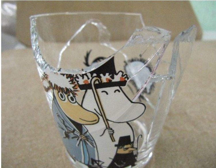
Kuvio 20: Lasin tyypillinen kolmiomainen rikkoutumistyyli. (Kuva ja kuvateksti Noora Vierimaa)
