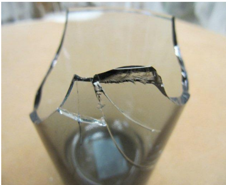
Kuvio 19: Lasin tyypillinen rikkoutumistyyli.(Kuva ja kuvateksti Noora Vierimaa)
