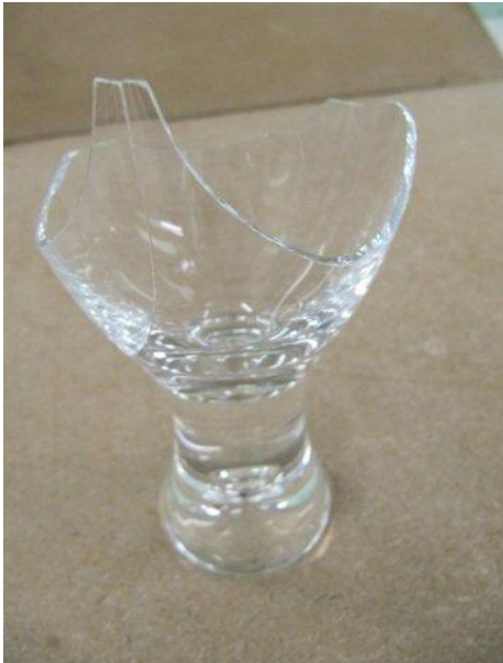
Kuvio 16: Tyypillinen kuva suupuhallettujen lasien rikkoutumistyylistä. Kuvasta voidaan havaita usealle lasille tyypillinen rikkoutumistyyli; reunat hajosivat lähes täysin. (Kuva ja kuvateksti Noora Vierimaa)
