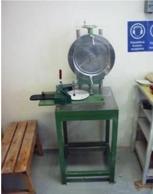
Kuvio 8: Iskunkestävyyden mittauslaite (Kuva: Anna von Hellens, kuvateksti Noora Vierimaa)
