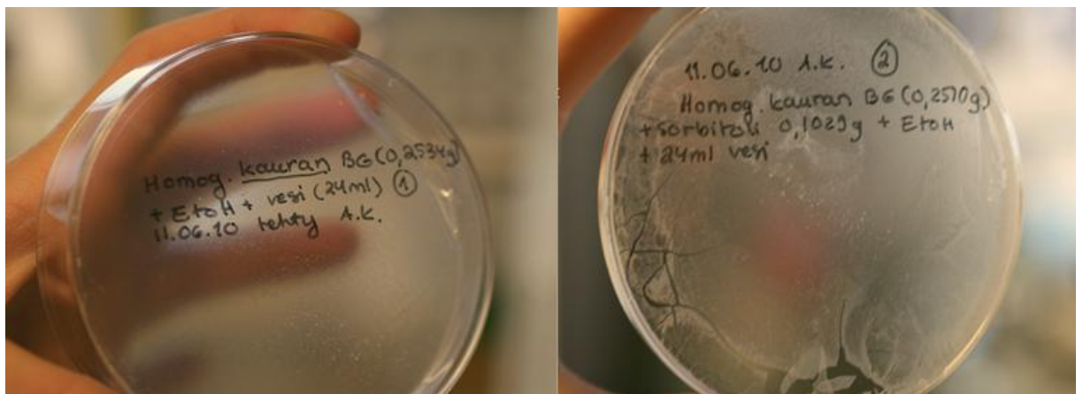
Kuva 28: Homogenoidut kauran beetaglukaanikalvot (ilman sorbitolia tehty vasemmalla ja sorbitolin kanssa valmistettu oikealla).
