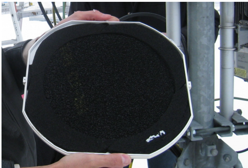
Kuva 17. Vaimennuspehmuste radomin sisäpinnalla
