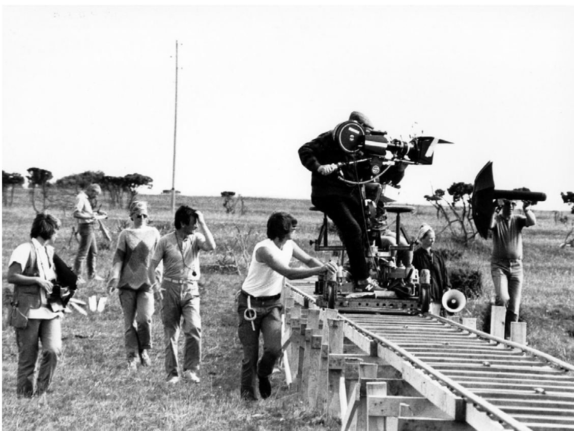
Kuva 13. Kiskojen käyttö on yleisin keino toteuttaa tasaisia kamera-ajoja.
