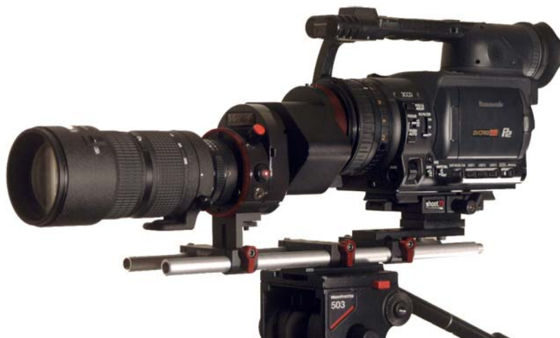
Kuva 8. SGBIade-merkkinen 35mm DOF-adapteri kiinnitettynä Panasonic HVX200 -videokameraan.
