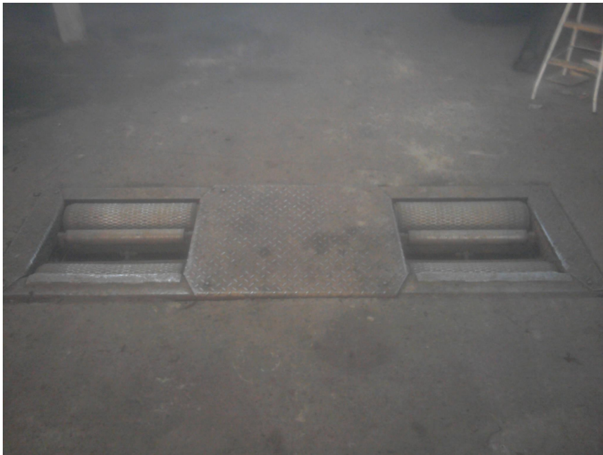
KUVA 6. Kevyen kaluston jarrudynamometrin telasto
