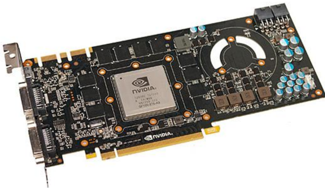
Kuva 2. GeForce GTX 480 ilman jäähdytintä
