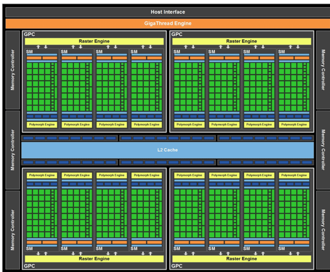
Kuva 3. Kaaviokuva Fermi-arkkitehtuurista (kuva: NVIDIA)
