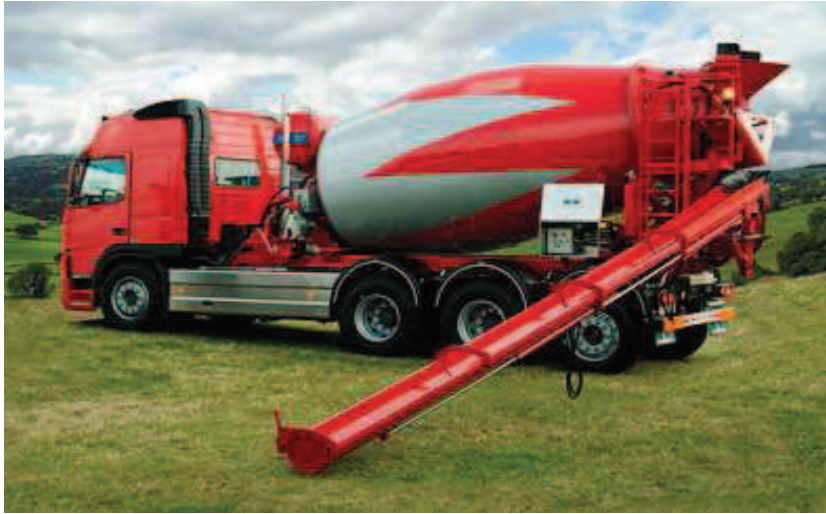
Figur 11. Betongbil med ränna färdig för gjutning /65/
