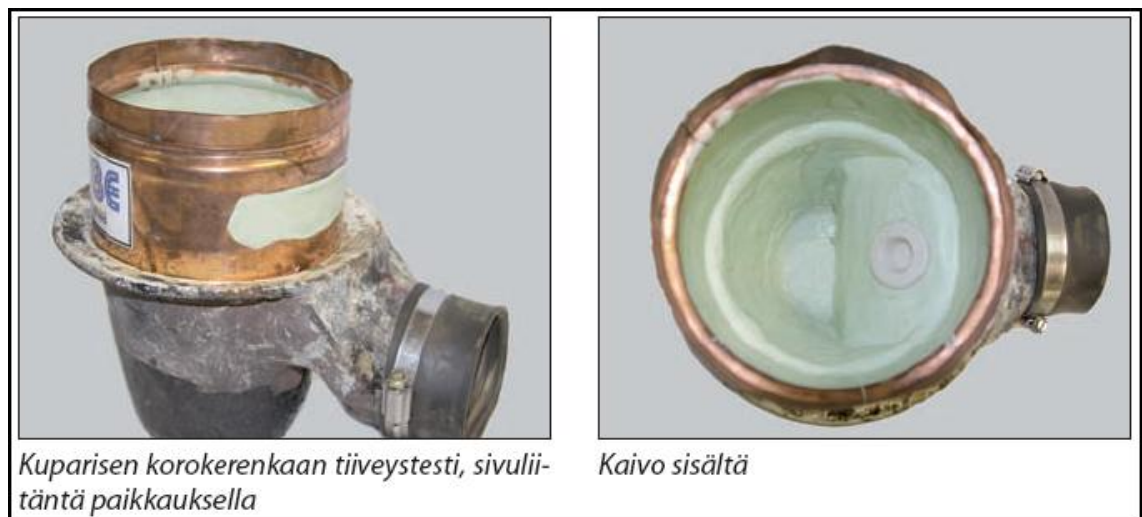
Kuva 22. Kuparisen korokerenkaan liitos valurautakaivoon (RT-kortti 37925).
