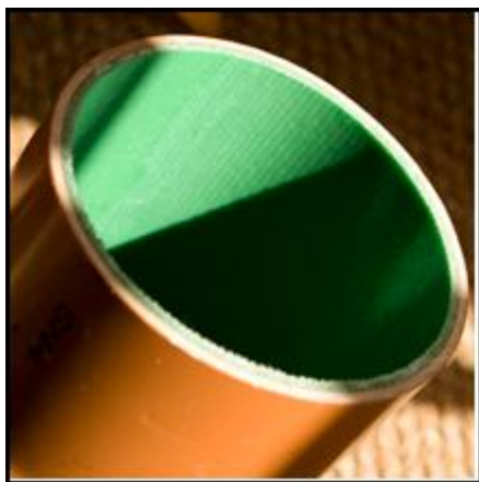
Kuva 15. Brawoliner-sukalla sujutettua muoviputkea (Picote Oy Ltd 2011).
