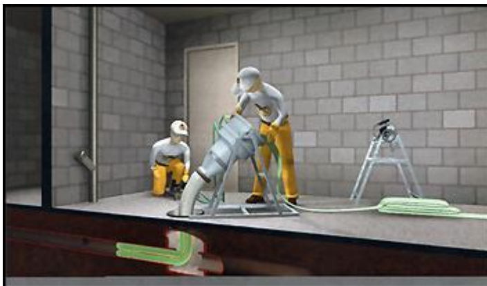
Kuva 24. Sukan sujutusta sujutustyökalulla (Suomen Putkisto Palvelu Oy 2011).
