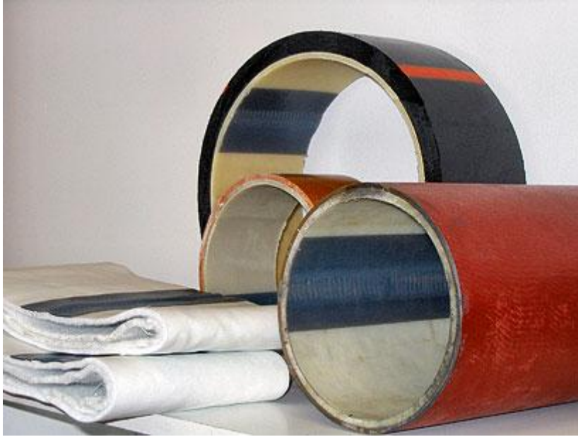
Kuva 4. Mallipaloja sukkasujutetusta putkesta sekä huopasukkaa, joka kyllästetään ennen sen sujuttamista viemäriin (Hietala 2008).
