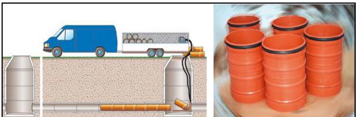
Kuva 11. MaxiLine-pätkäsujutus (Nordic Renovation Group 2011).
