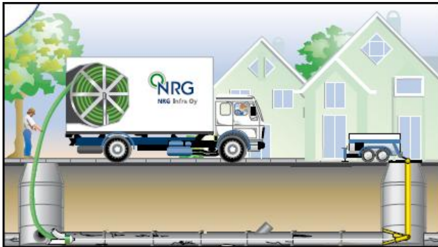
Kuva 9. Omega-Liner -muotoputkisujutus (Nordic Renovation Group 2011).
