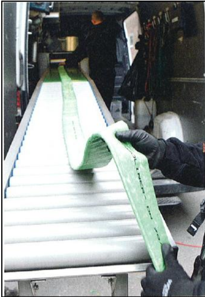
Kuva 16. Epoksihartsilla kyllästetty sukka tehtaan mankelipöydällä (Picote Oy Ltd 2011).
