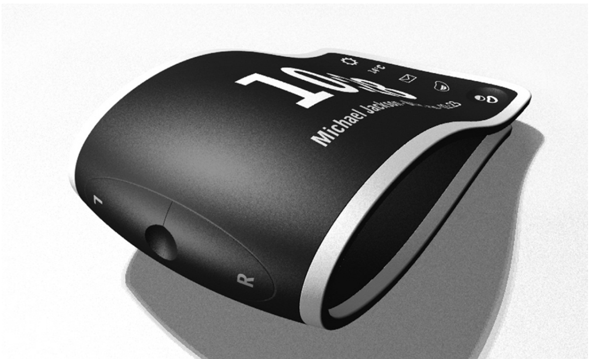
Kuva 6. Ikonin mobiililaitteen rendauskuva esimerkillisen grafiikan ja käyttöliittymän kanssa. Malli tehty Rhinoceros 3D –mallinnusohjelmalla. Jukka Isosaari
