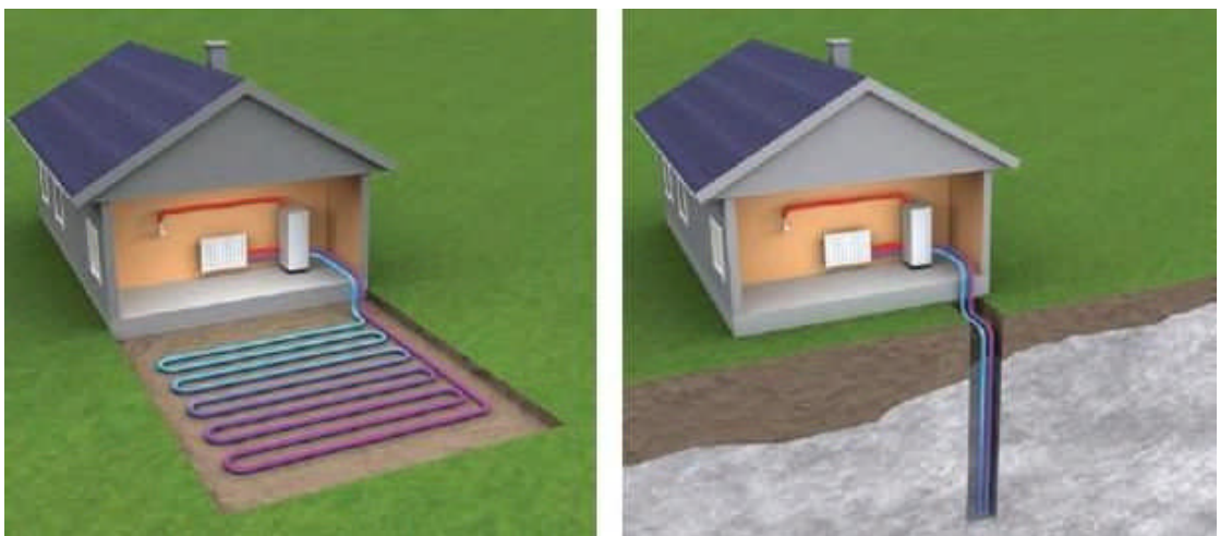
KUVA 2. Maalämmön keruujärjestelmät: vasemmalla maapiiri ja oikealla lämpökaivo. /19./
