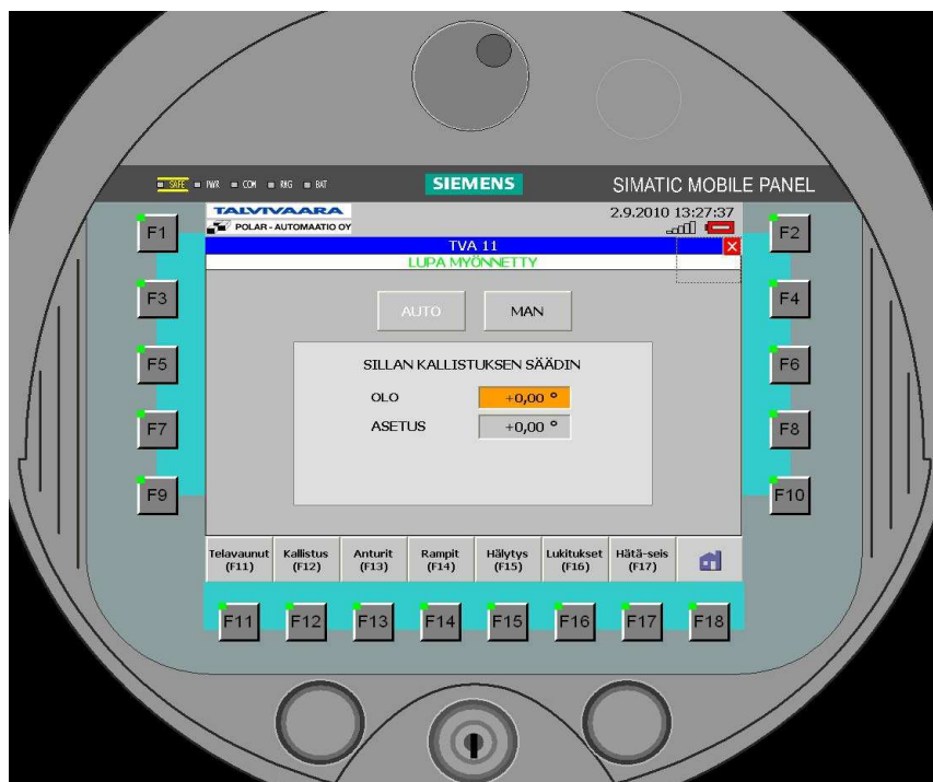
Kuva 15. Sillan kallistuksen säädin (automaatti)
