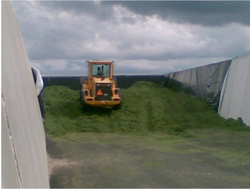
Kuvio 9. Pyörökuormaimella rehun kuormaus ja tiivistys käy tehokkaasti. (Juha Ketola)
