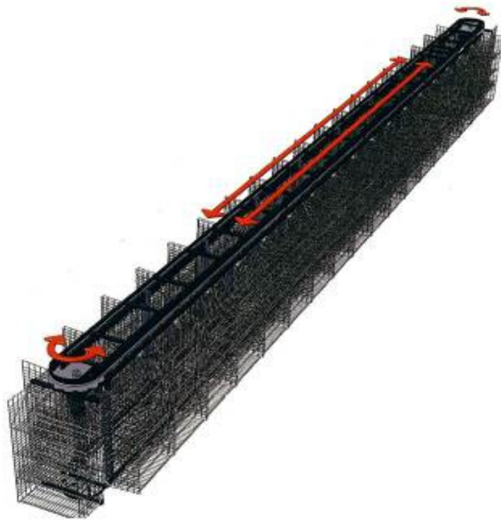
Kuva 27. Vaakatasossa oleva varastokaruselli Kasten HOCA [13]
