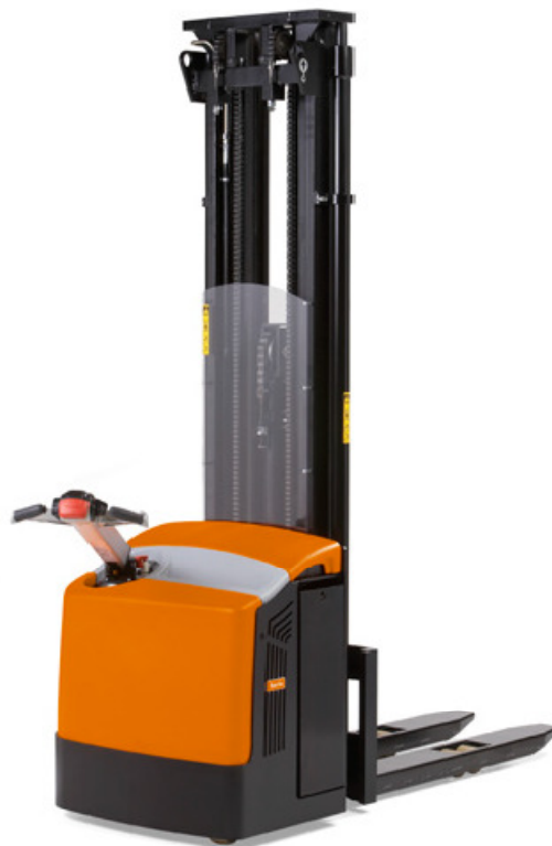
Kuva 16. Rocla Oy:n SWac-pinoamistrukki [9].
