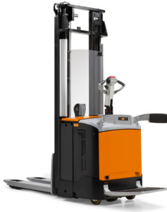
Kuva 17. Rocla Oy:n SPac-pinoamistrukki [10]
