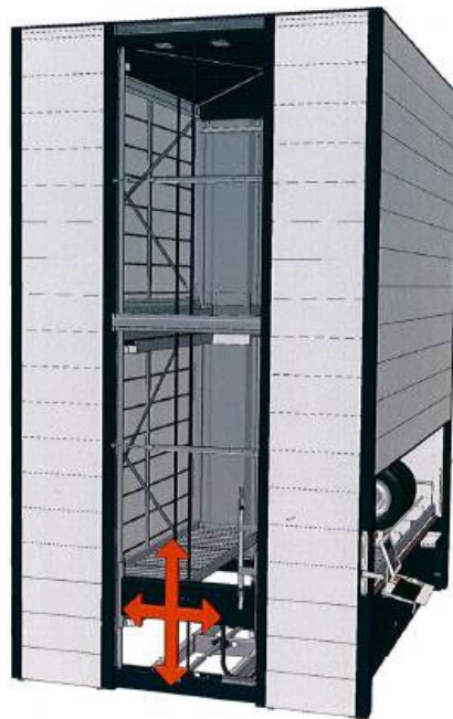
Kuva 26. Hissityyppinen varastoautomaatti Kasten Tornado [13]
