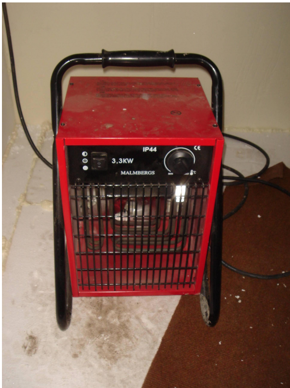
Kuva 23. Tilojen lämmityksessä käytetty kierrätysilmalämmitin.
