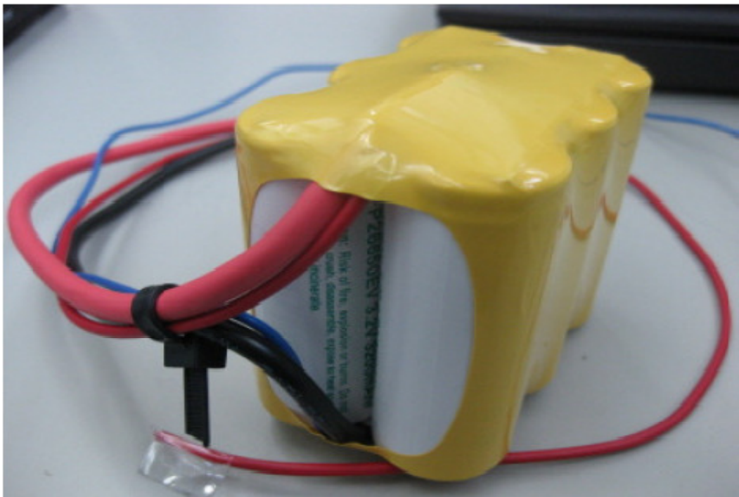
Kuva 5. Kuusi rinnan kytkettyä akkubatteria.
