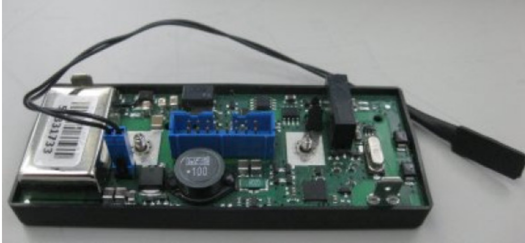
Kuva 6. BMBU6 ja NTC lämpötila-anturi.
