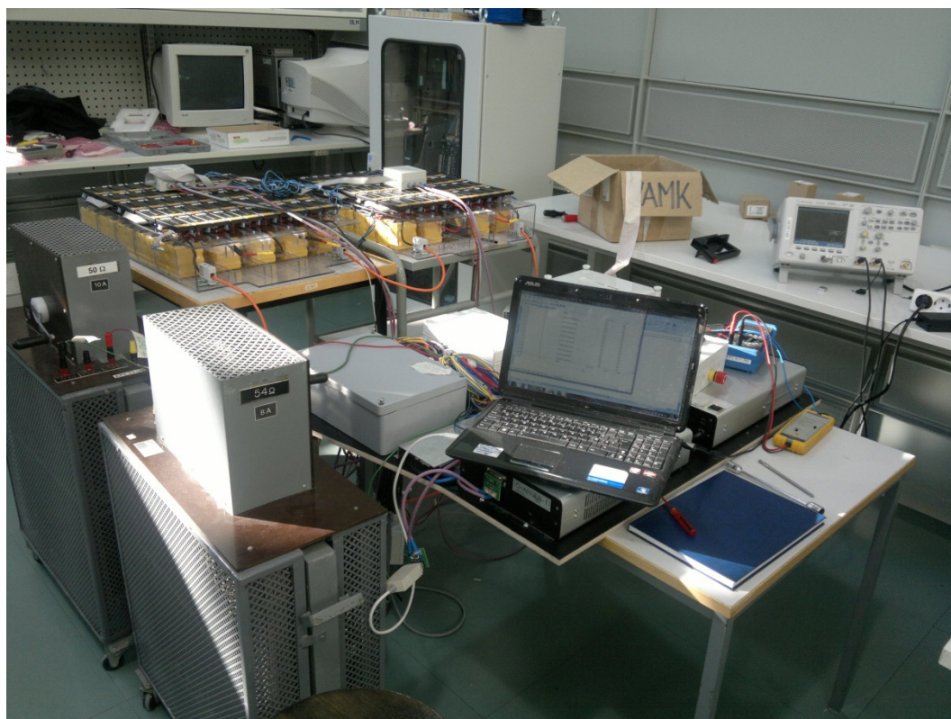
Kuva 14. DC-välipiirin latauksen testaus
