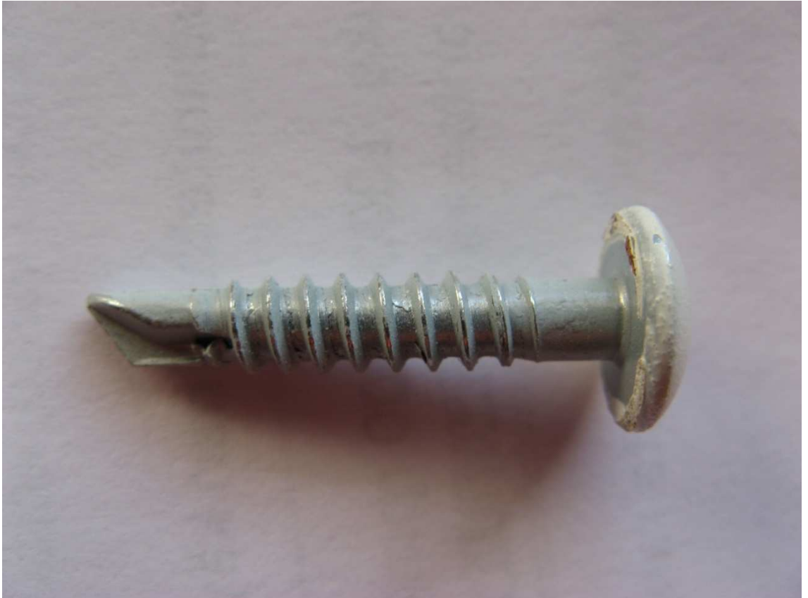
Kuva 8. Kuitusementtilevyn kiinnitykseen tarkoitettu ruuvi. Kuva Iiro Mutanen 2010.
