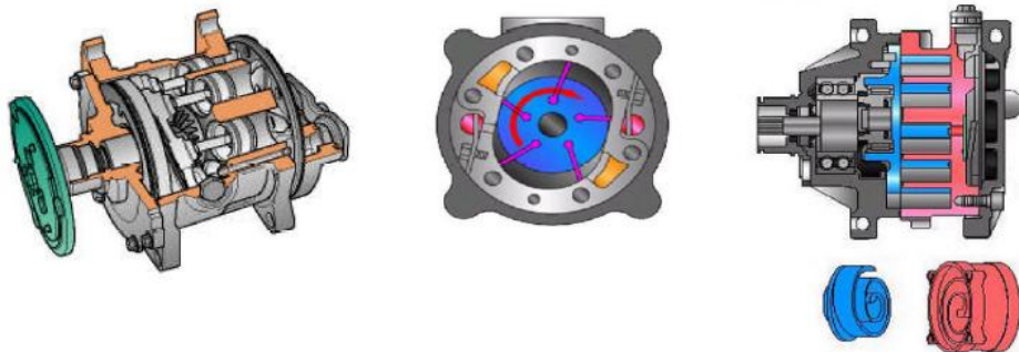
KUVA 7. Vinolevymäntä-, siipi- ja spiraalikompressori (11, s. 25)
