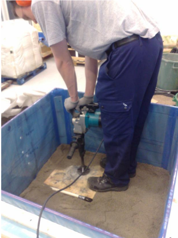
KUVA 15. Masuunihiekan tiivistys poravasarella
