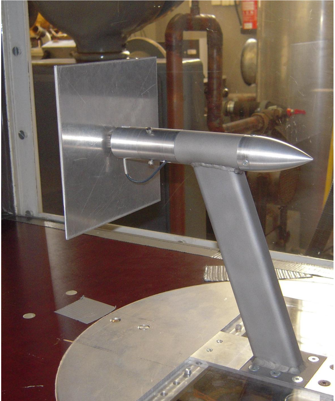
Kuva 15. Kappaleiden kiinnitys voima-anturiin.
