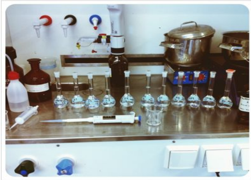
Kuva 16. Vesinäytteiden kestävänti 100 ml:n mittapulloihin 1000 \mu l Finnpietillä Viitaniemen pintavesilaitoksen laboratoriossa
