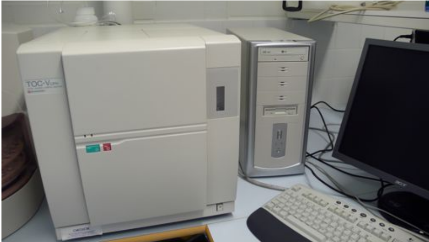
Kuva 18. NPOC-mittaukset TOC-Vcph (Total organic carbon analyzer) Shimadzu, SFS-EN 1484
