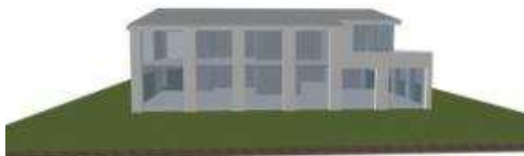
Figur 6. Vy över fasaden i ett tidigt skede. Uppe i högra hörnet noterar man hålrummet balkongen orsakar.
