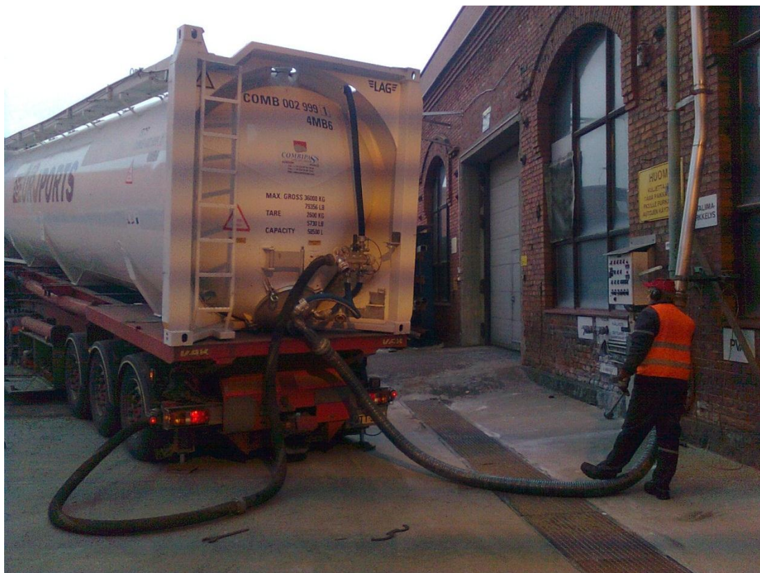
Kuva 13. Kontti kytkettynä loppuasiakkaan purkuyhteyteen (Kuva: J. Reinisalmi).
