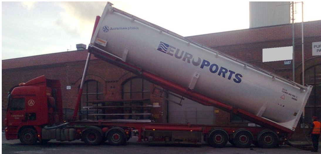
Kuva 14. Kontti kallistettuna tuotetta purettaessa (Kuva: J. Reinisalmi).
