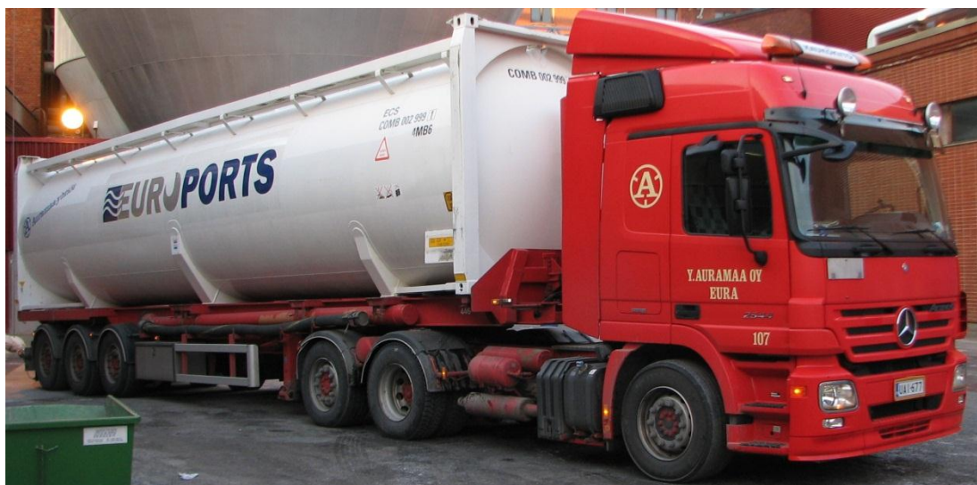
Kuva 12. Puoliperävaunun yhdistelmä kippaavalla konttikärryllä (Kuva: J. Reinisalmi).
