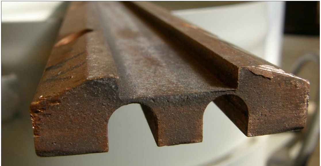
Kuva 17. Muokattu juurituki, jonka leveys on 16 mm ja syvyys 2 mm.
