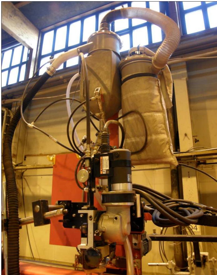
Kuva 8. Ylhäällä oikealla jauhesäiliö, ylhäällä vasemmalla jauheensuodatin ja näiden alapuolella langansyöttökoneisto.
