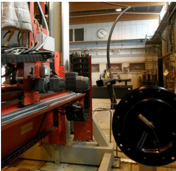
Kuva 9. Lankakela ja lankakaapeli, jota pitkin hitsauslanka kulkee hitsauspäälle.
