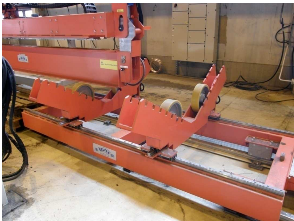
Kuva 13. Hitsauspyytä vasemmalla ja alhaalla pyöritysrollasto, joka laitetaan hitsauspyydän alle pyöreitäkappaleita hitsattaessa.
