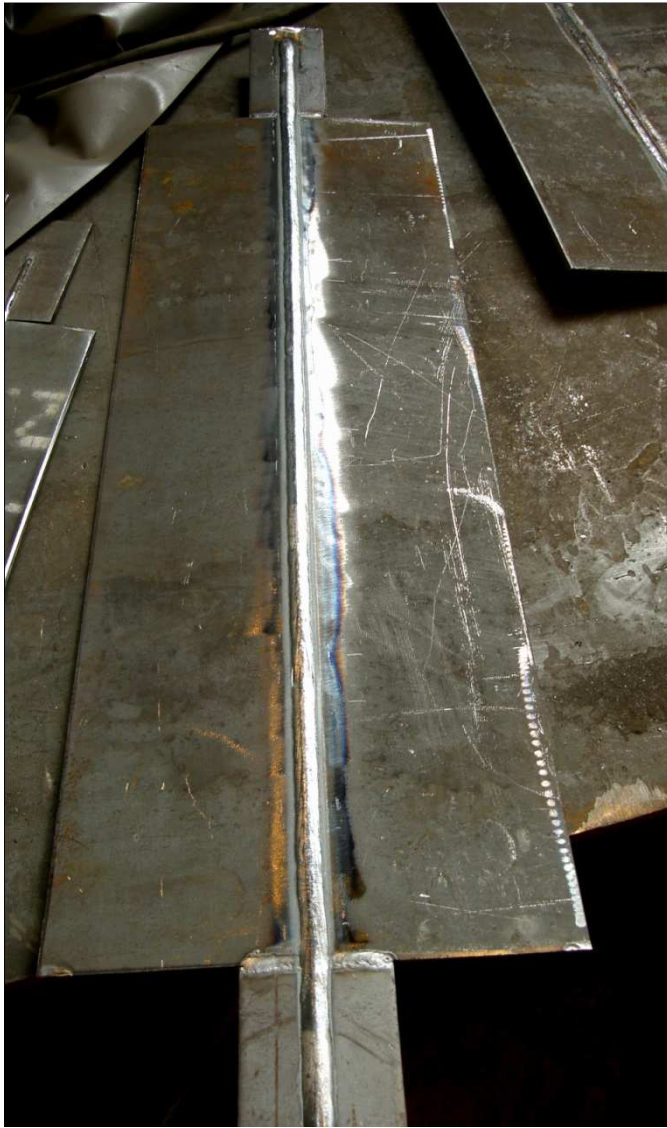
Kuva 20. Hitsattu koelevy aloitus- ja lopetuspaloilla.
