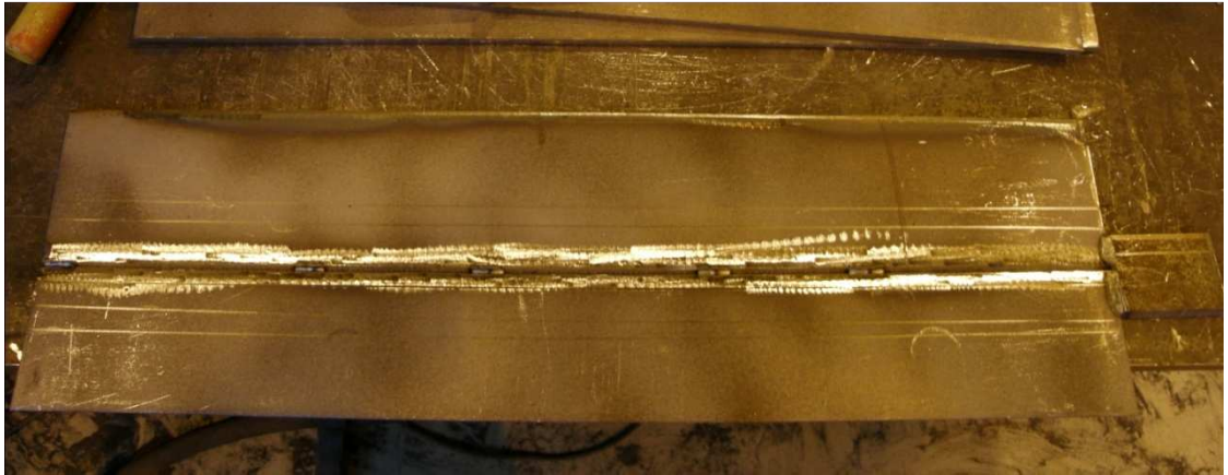
Kuva 18. Silloitettu koelevy aloituspalalla.
