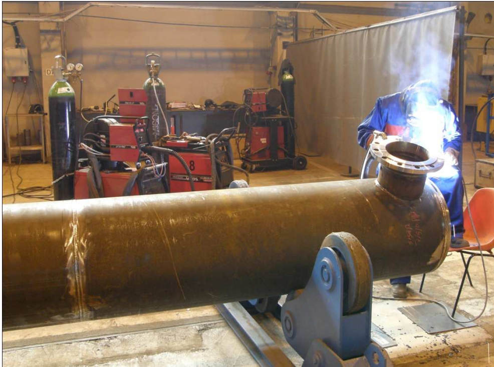
Kuva 16. Lämmönsiirtimenvaipan hitsausta MAG-hitsauksella.
