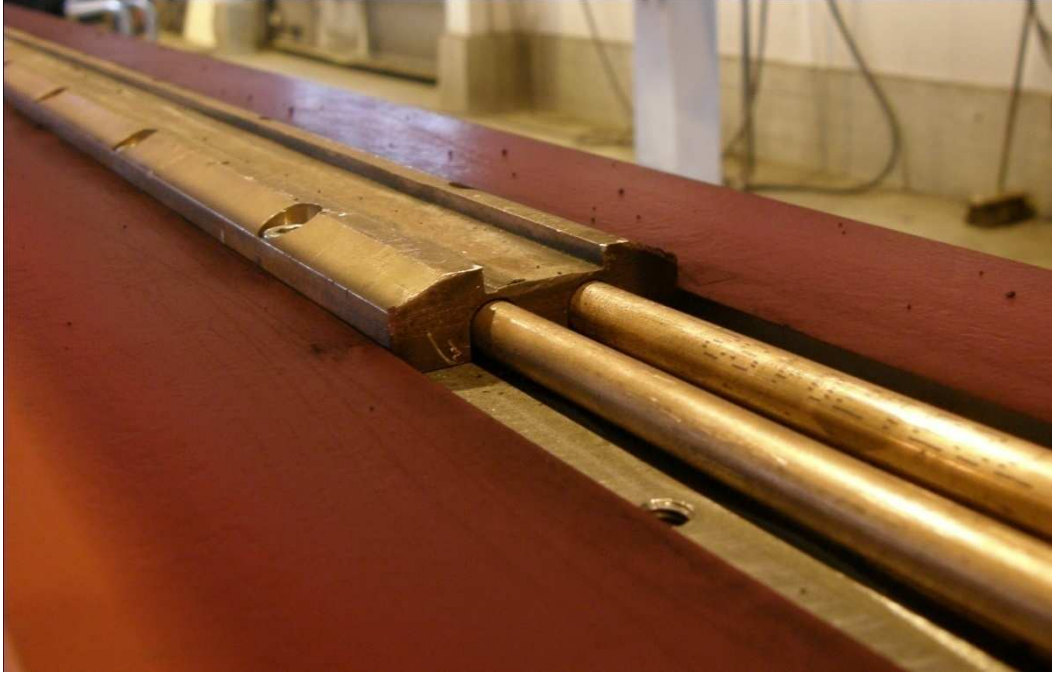
Kuva11. Juurituki ja jäähdytysputkistot.
