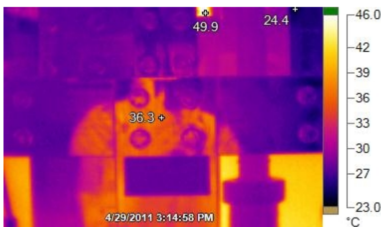
Kuva 7. Lämpösäteilyn heijastuminen kuparista. (Kuva: Kalle Mononen)
