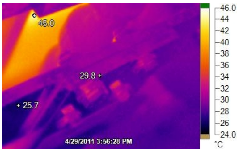
Kuva 3. Altaan 317 etupuolen kuparitahnasta puhdistettu katodikiskon väljä liitos. Altaan toinen puoli on kiristetty normaalisti. 500 A (Kuva: Kalle Mononen)
