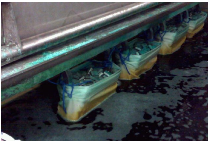
Kuva 1. Nikkelikylvyn anodikorit kiinnitettynä anoditankoon. (Kuva: Kalle Mononen)
