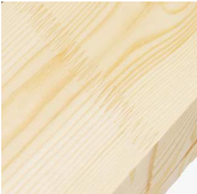
KUVIO 2. Esimerkki sormijatkoksesta (Rakennustietosäätiö RTS 2009)
