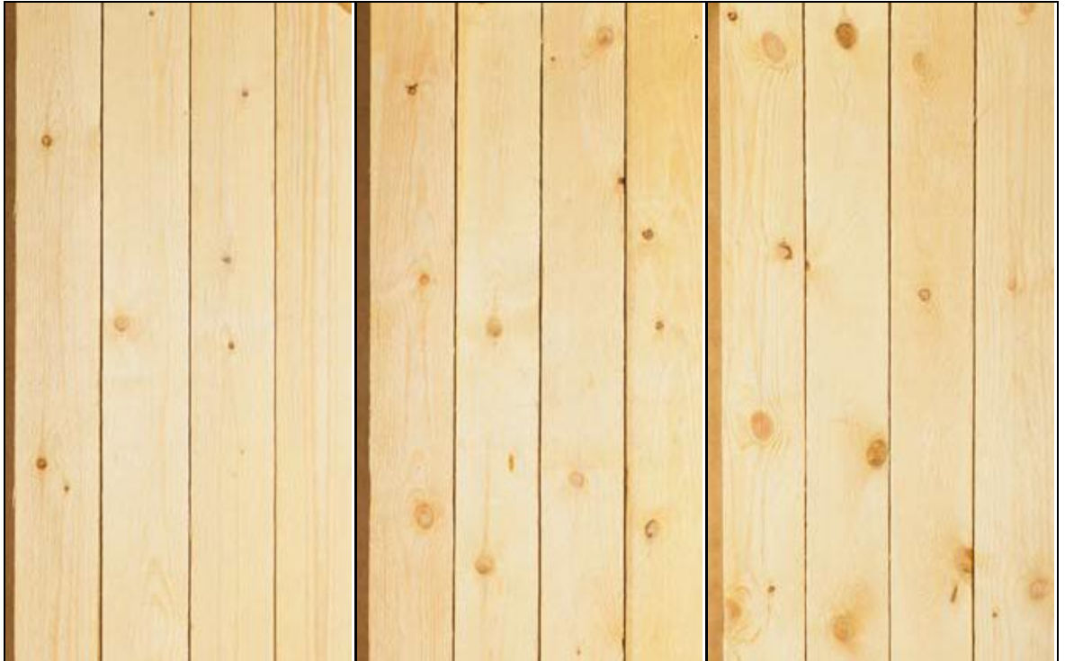
KUVIO 1. Sahatavaran laatuluokat A, B ja C vasemmalta lukien (Rakennustietosäätiö RTS 2009.)
