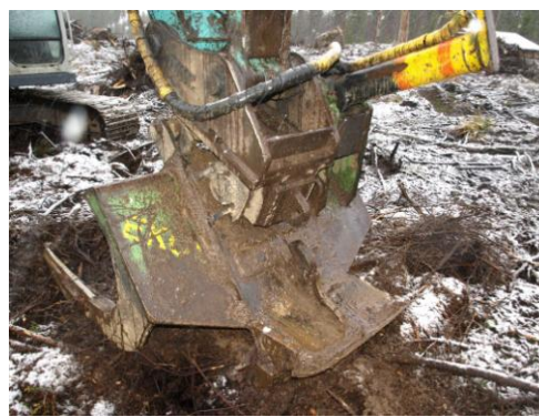
Kuva 5. Kantoharassa on mätästyslevy. Kuva: P. Tiusanen
