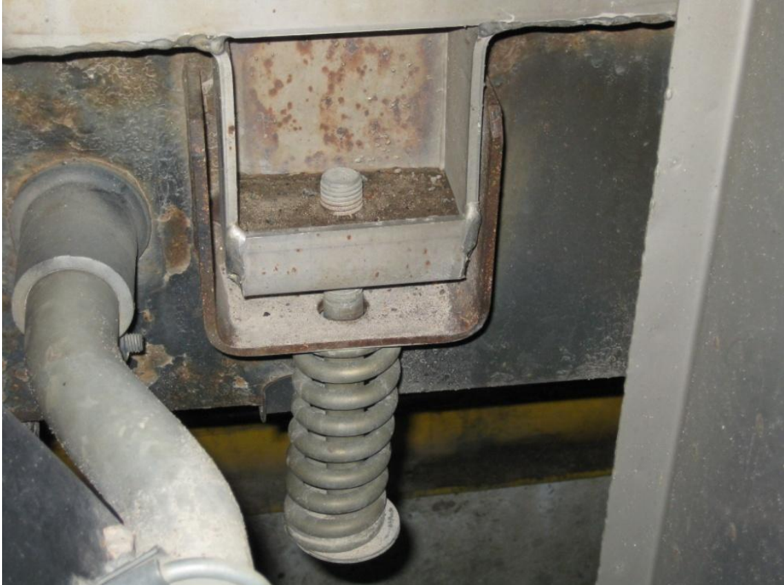
KUVA 5. Säiliörakenteen kiinnitysjosui maitoauton alustassa
