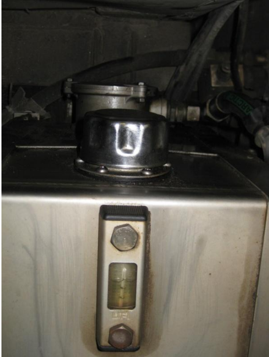
KUVA 6. Hydraulikkaöljysäiliö maitoauton kyljessä
