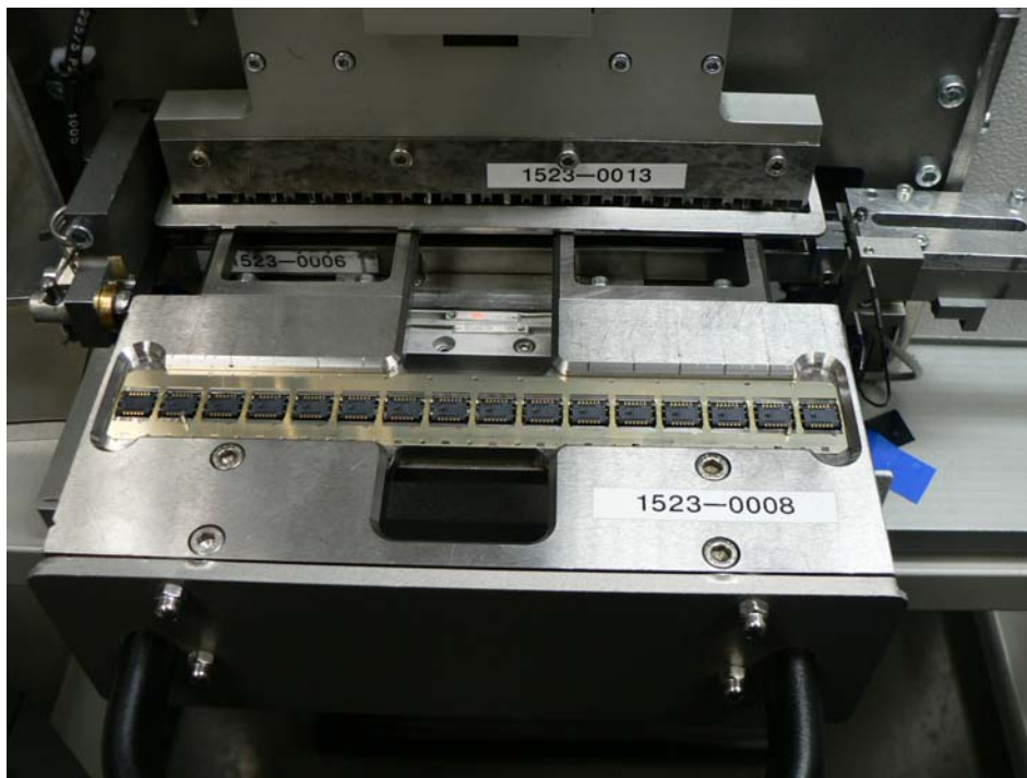
Kuva 7. Johdinkehys asetettuna erottelupöydälle.
