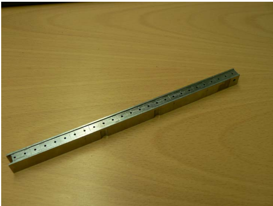
Kuva 10. Alavasteessa on pienet reunat, jotka pyrkivät oikaisemaan tuotetta työnnon aikana.
