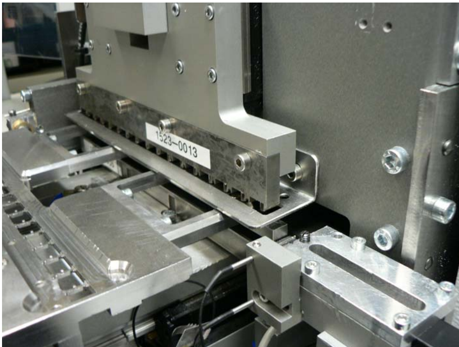
Kuva 9. Johdinkehysten irrotin asennettuna.
