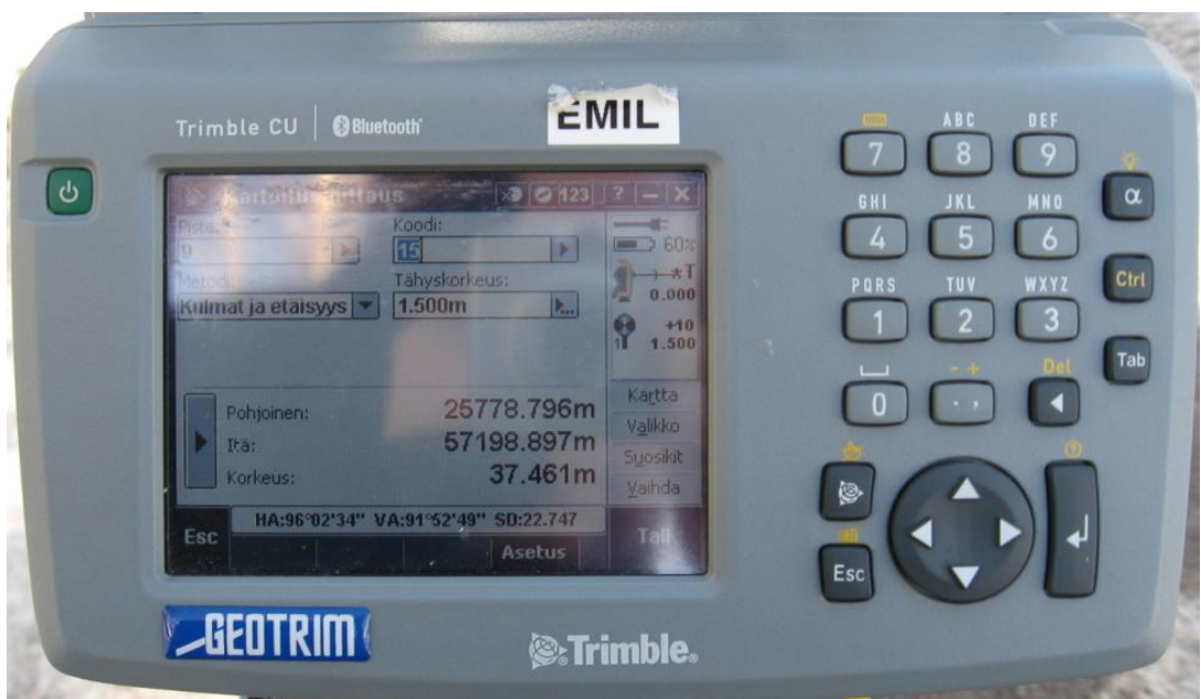
Kuva 13. Trimble CU:n käyttöliittymä
