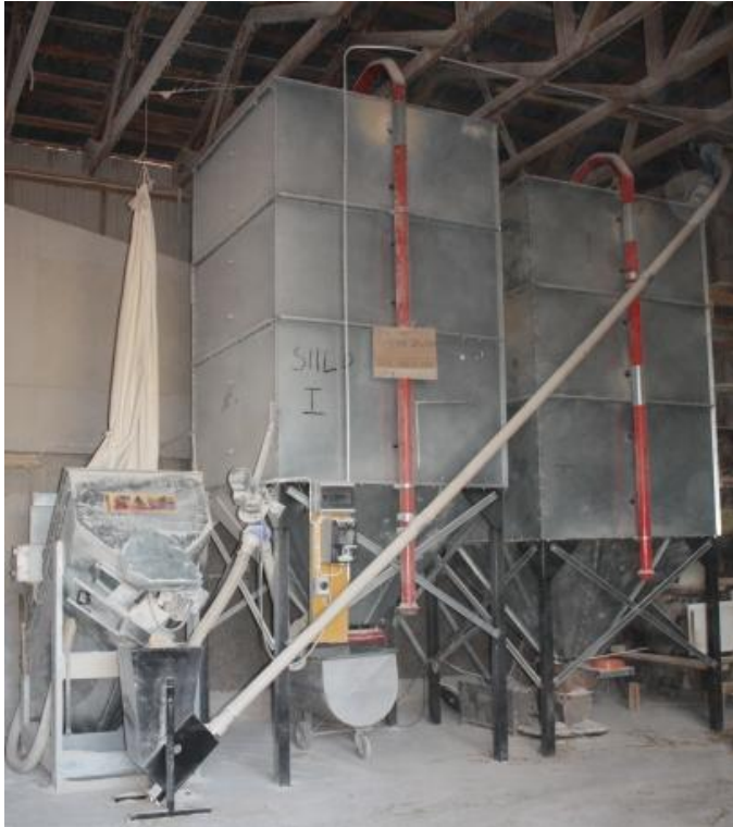
Kuva 1. Kuvassa vasemmalla on jauhomylly. Oikealla olevat siilot ovat rehusiiloja. Ainoastaan keskellä olevaan siiloon toimitetaan teollista rehua.
