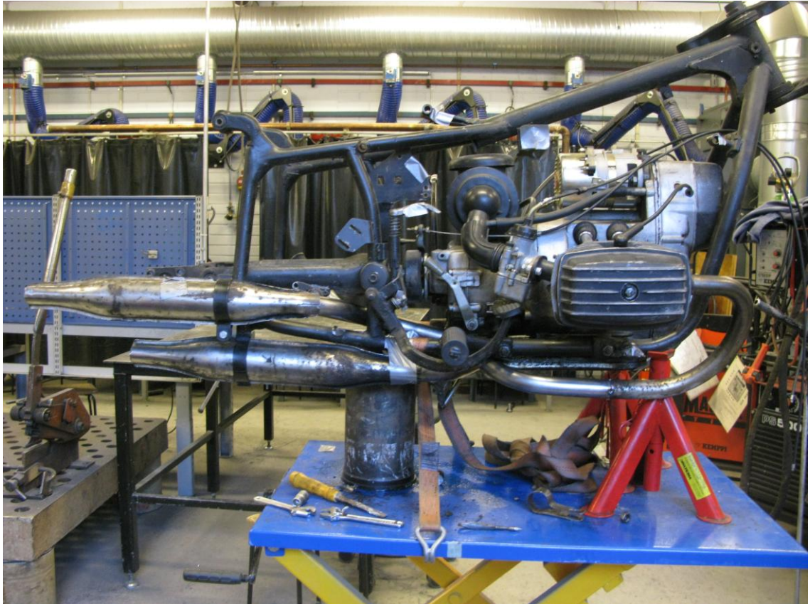
Kuva 47. Mike & Mack -pakoputket on sovitettuna runkoon.
