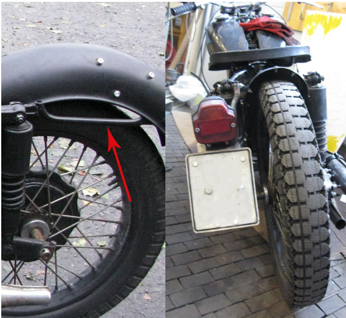
Kuva 61. Takavalon ja rekisterikilven teline syntyi vanhasta takalokasuojan tuesta.
